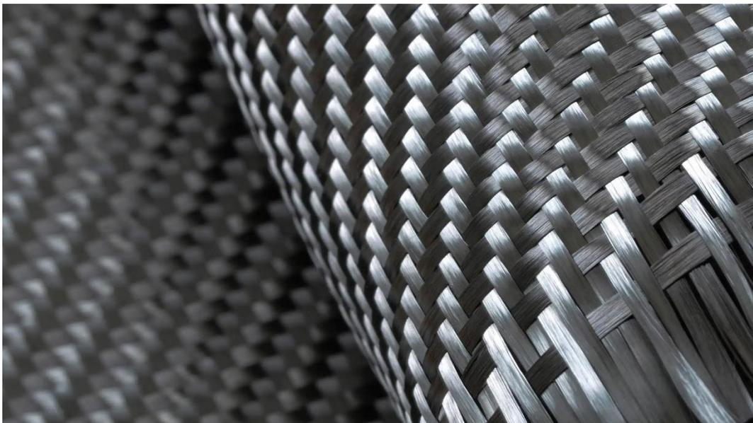
Slika 17. Ugljična vlakna [21]
