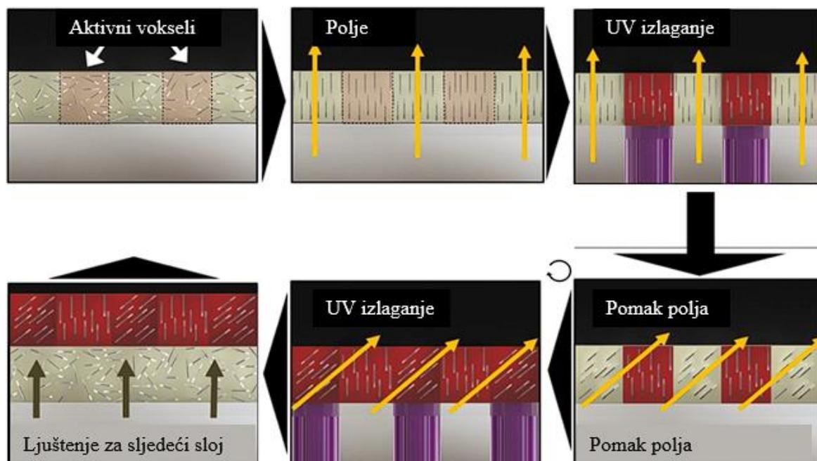
Slika 18. Kontrola vlakana tijekom izrade dijelova [19]
