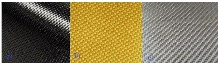
Slika 7. Ugljična, aramidna i staklena vlakna [11]
