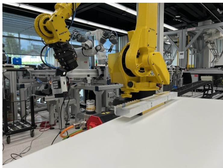
Slika 2. Sustav laser-kamera montirani na robotu Fanuc M710
