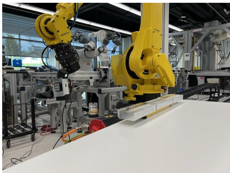
Slika 2. Sustav laser-kamera montirani na robotu Fanuc M710
