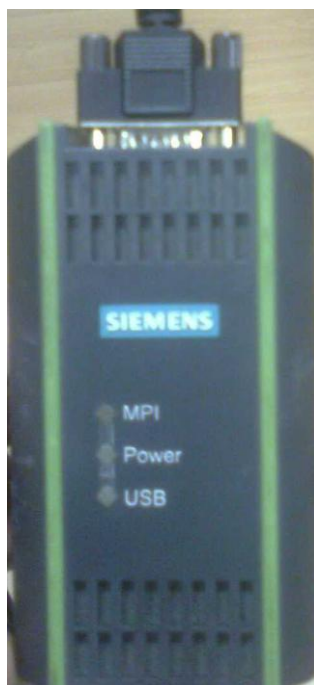
Slika 2.4 Adapter za komunikaciju sa S7-200
