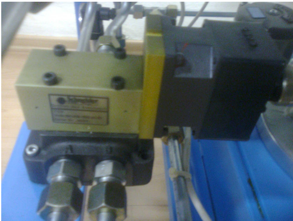
Slika 3.5. Prikaz servoventila koji se koristi za regulaciju
