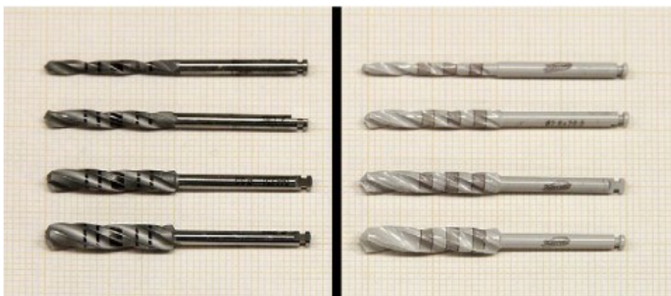
Slika 33. Svrdla: čelična (lijevo) i keramička (desno) [52]
