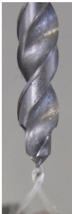
Slika 30. Dvostupnjevano svrdlo promjera 4,5 mm s kanalima za unutarnje hlađenje [47]
