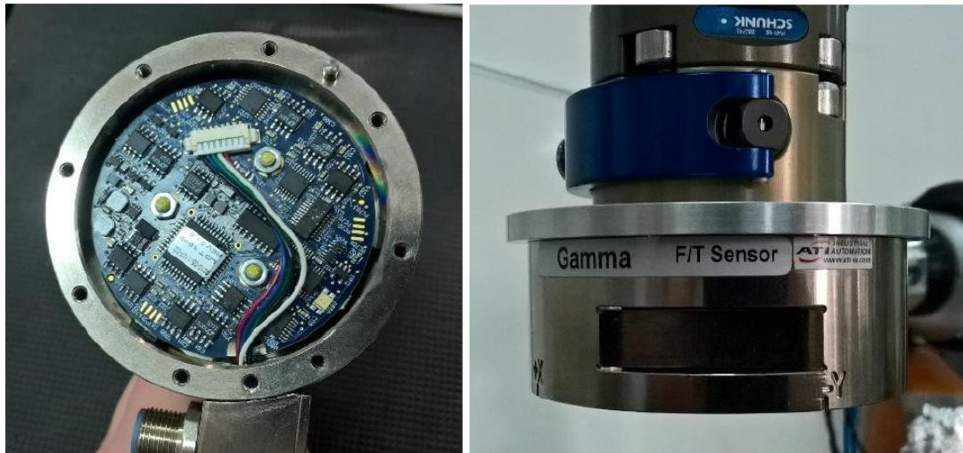
**Slika 65. Sklop osjetnika i pretvornika Gamma [74]**
