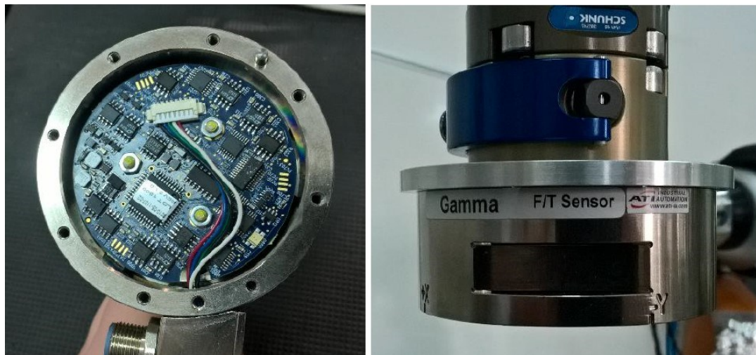
Slika 65. Sklop osjetnika i pretvornika Gamma [74]
