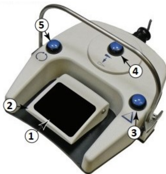
Slika 70. Kontrolna jedinica s pedalom [75]
