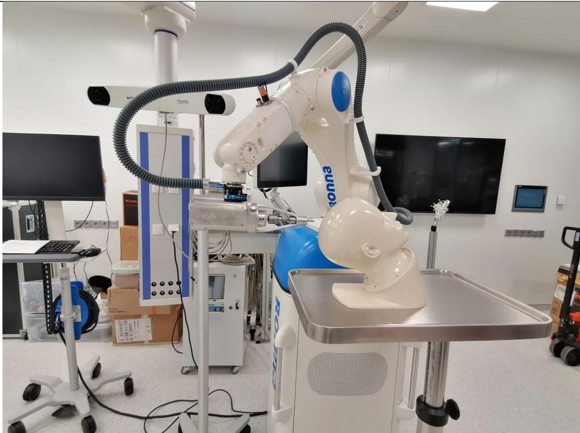
Slika 63. Prototip bušilice i robotski sustav RONNA
