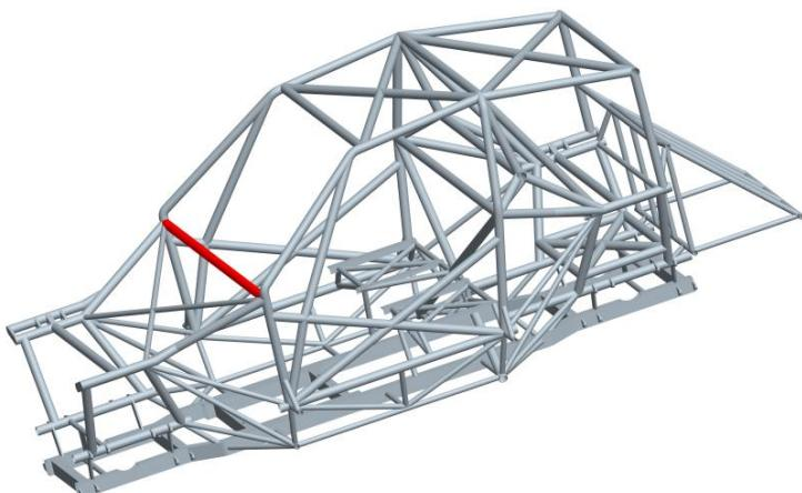
Slika 10. Poprečna cijev za pojačanje primijenjena na rešetci
