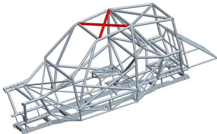
Slika 12. Oblik krovnog pojačanja primijenjen na rešetci (inačica a) na slici 11.).
