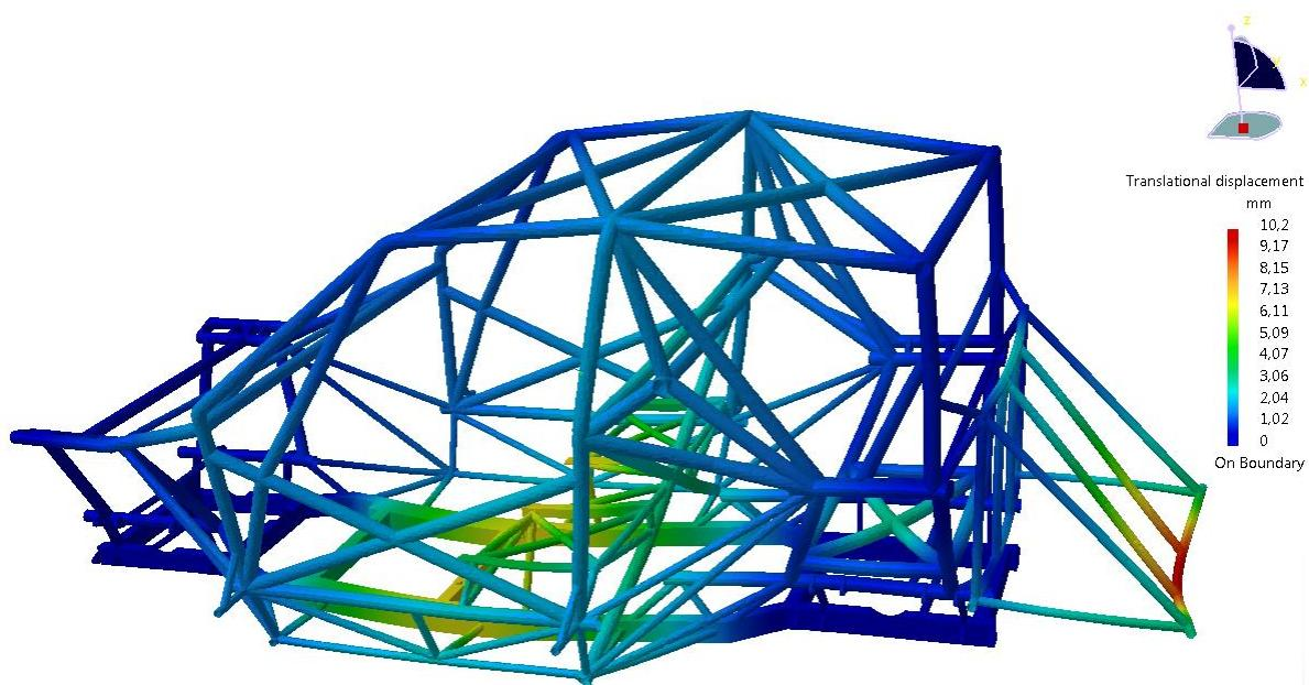
Slika 46. Deformirani oblik rešetke s raspodjelom pomaka za vertikalno ubrzanje od 20g
