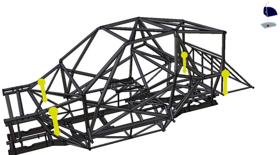
Slika 36. Smjer djelovanja vertikalnog ubrzanja  $g$
