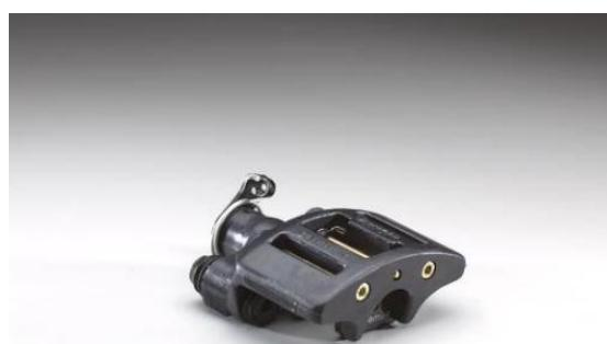
Slika 56. Čeljust parkirne kočnice, Brembo, tip 22.5882.11/21, [9.]
