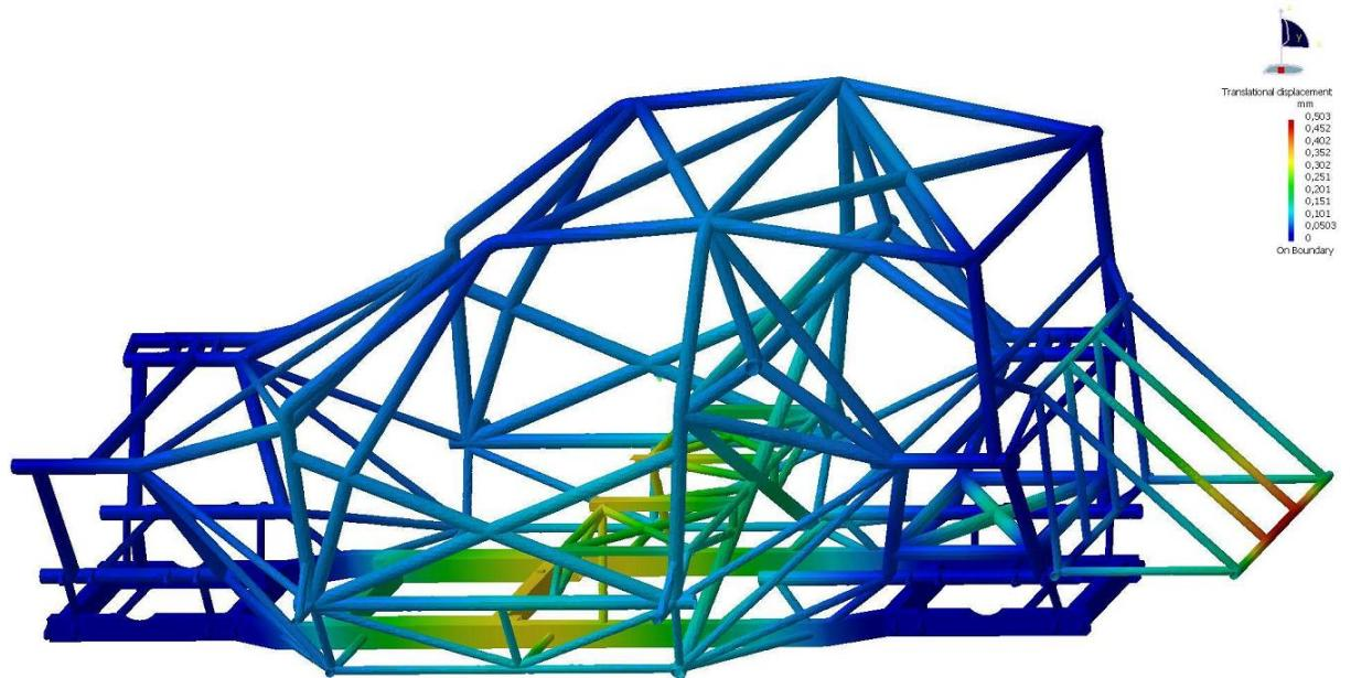
Slika 40. Deformirani oblik rešetke s raspodjelom pomaka za vertikalno ubrzanje od 1g
