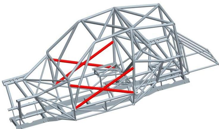
Slika 8. Oblik pojačanja vrata primjenjen na rešetci (inačica b) na slici 7.).
