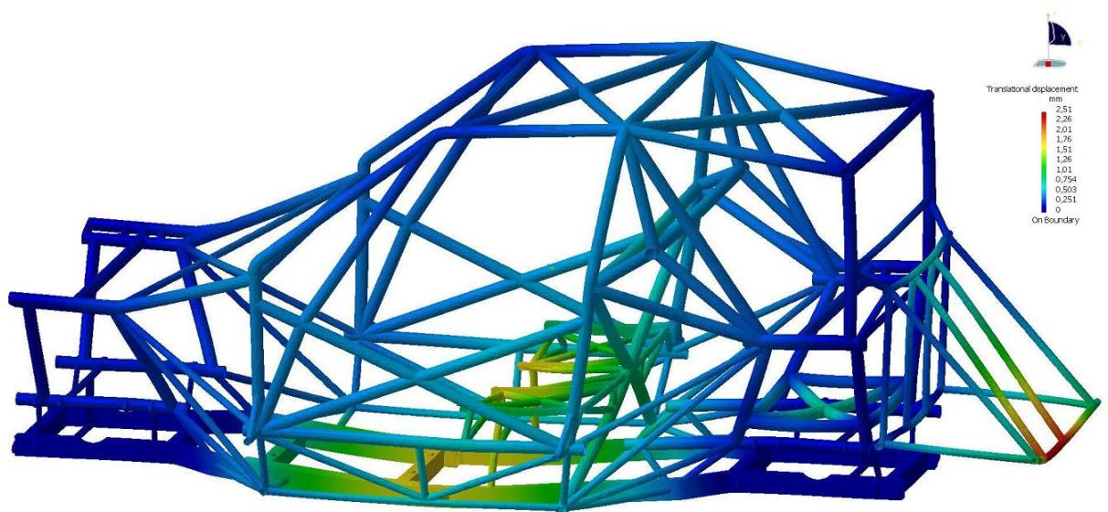
Slika 43. Deformirani oblik rešetke s raspodjelom pomaka za vertikalno ubrzanje od 5g
