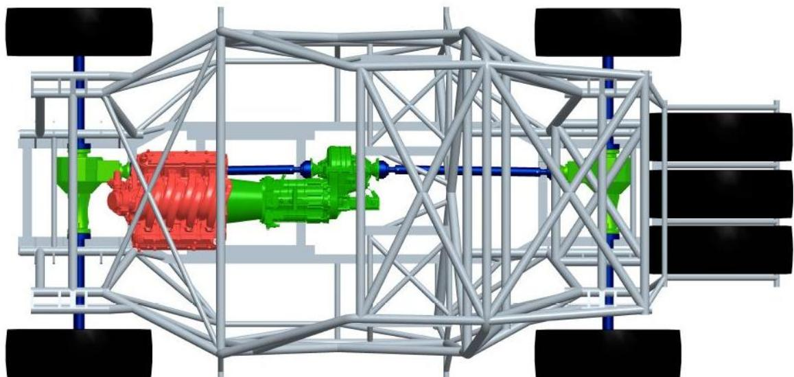
Slika 59. Rešetka s pogonskim sustavom, tlocrt
