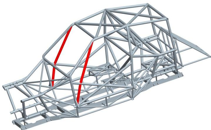
Slika 14. Pojačanje vjetrobranskog stupa primijenjeno na rešetci
