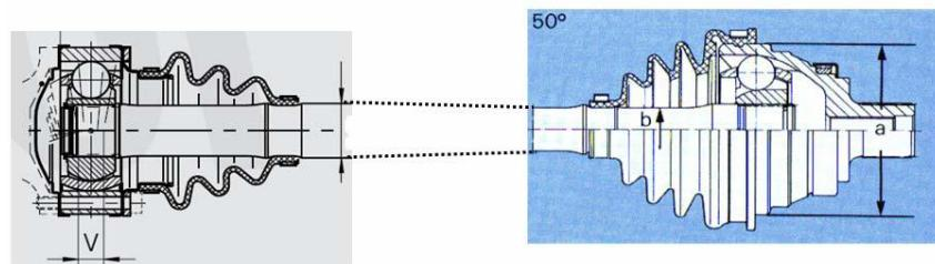
Slika 51. Shematski prikaz pogonskog vratila, GKN UF4600i
