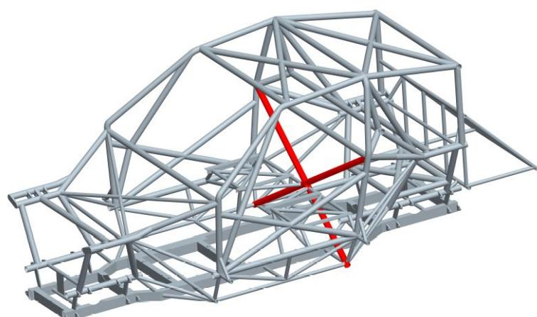
Slika 6. Oblik dijagonalnih cijevi primijenjen na rešetci
