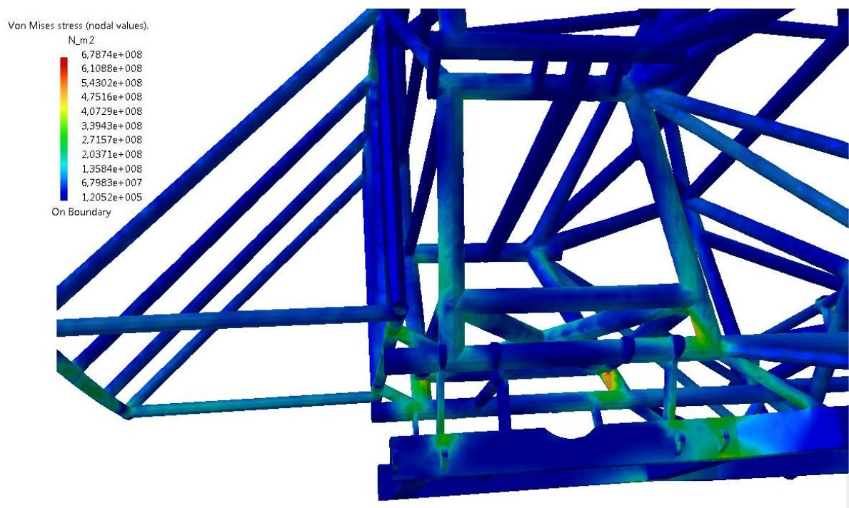
Slika 45. Detalj najvećeg naprezanja za vertikalno ubrzanje od 20g
