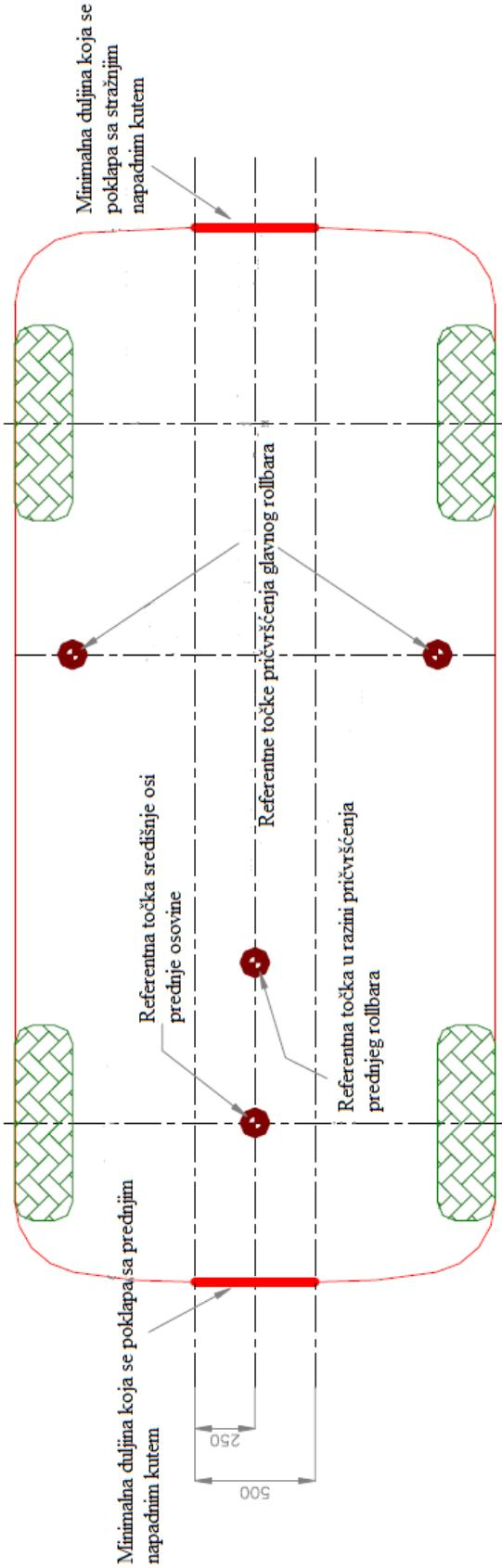
Slika 20. Shematski prikaz vozila grupe T1, 4x4, u horizontalnoj projekciji, s položajem referentnih točaka.
