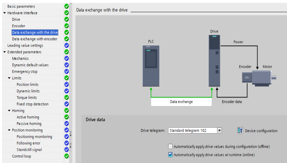
Slika 20. Odabir standardnog telegrama 102 za razmjenu podataka s regulatorom
