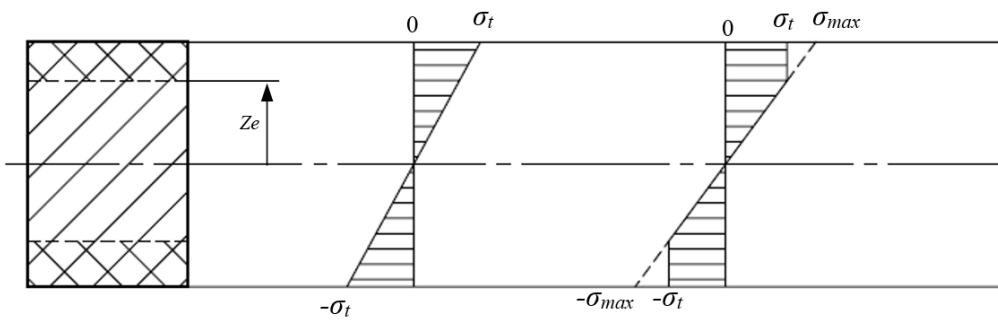
**Slika 15. Prikaz raspodijele naprezanja po poprečnom presjeku presjeku za  $M_y = M_{y,T}$  (lijevo) i  $M_y > M_{y,T}$  (desno)**
