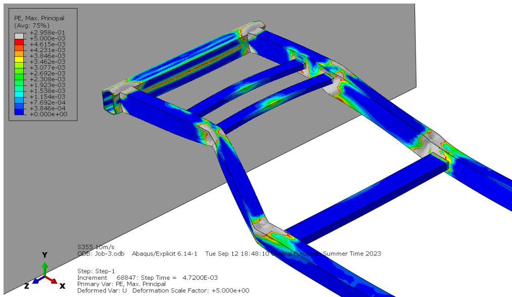
**Slika 29. Prikaz plastičnih deformacija za brzinu udara 10 m/s**
