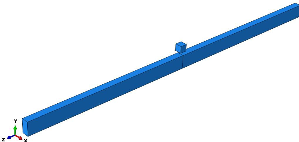
**Slika 5. Sklop grede i udarnog tijela**
