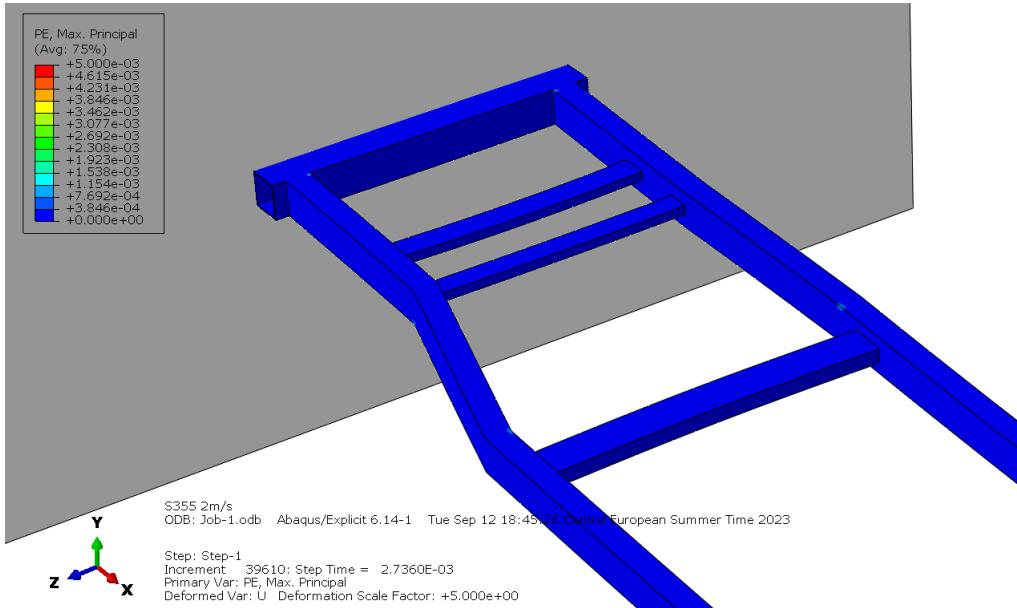
**Slika 25. Prikaz plastičnih deformacija za brzinu udara 2 m/s**
