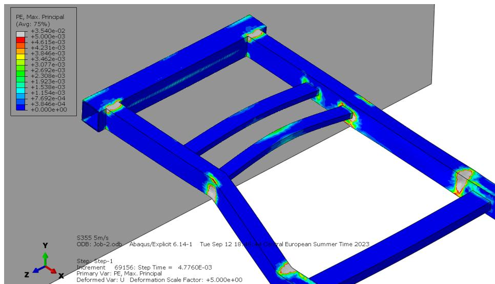
**Slika 27. Prikaz plastičnih deformacija za brzinu udara 5 m/s**
