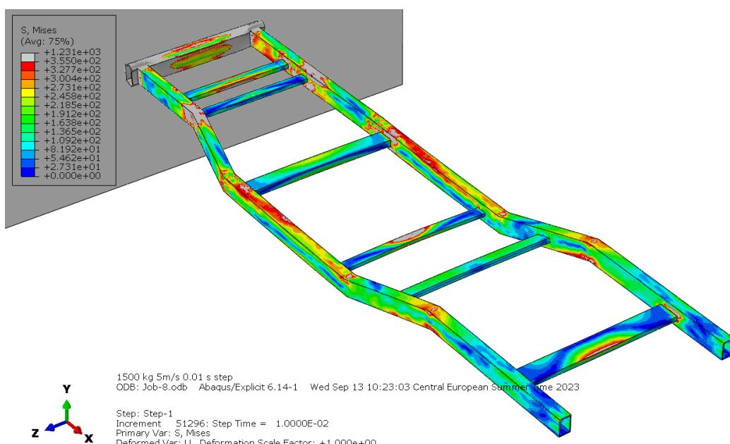
**Slika 33. Prikaz kontura Von Misesova naprezanja za ravnomjernu raspodjelu mase pri brzini udara 5 m/s**
