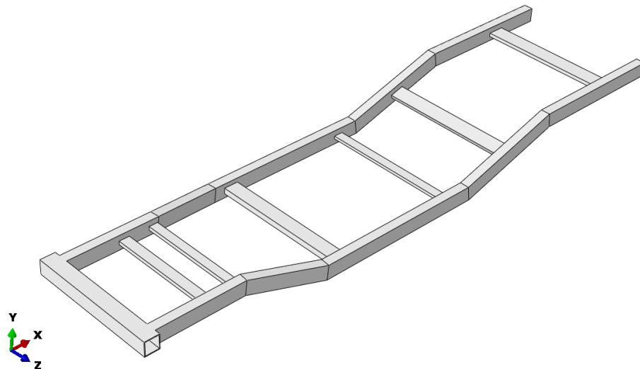
Slika 18. Okvir automobila sa pojednostavljenjima prema nacrtu [8]
