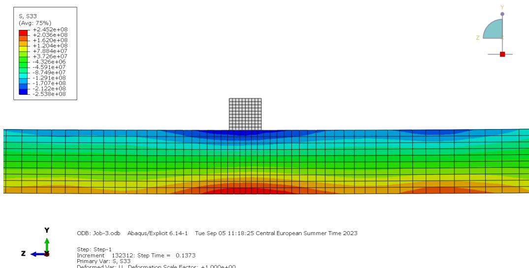
**Slika 11. Prikaz kontura naprezanja S33 u trenutku  $t=0,1373$  s**
