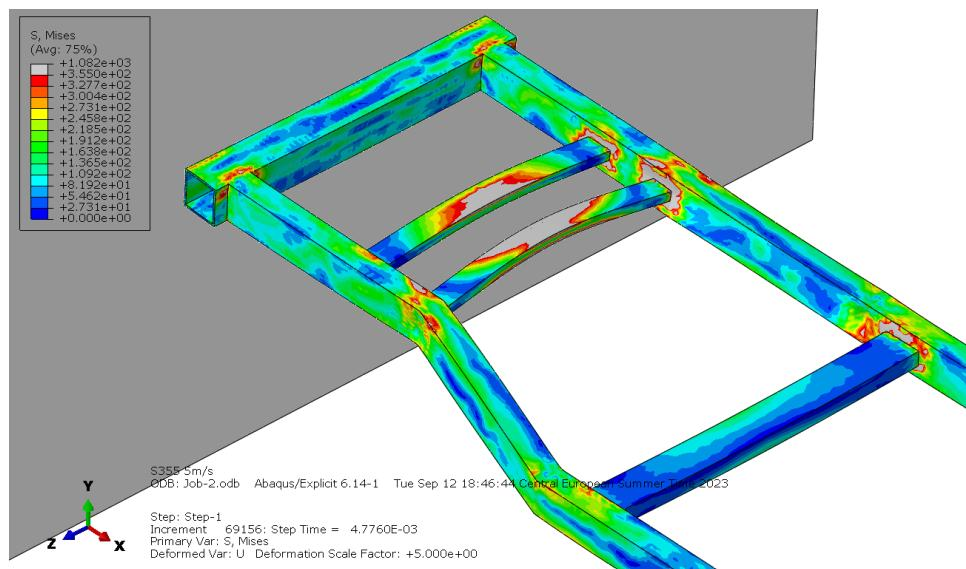
**Slika 26. Prikaz kontura Von Misesovog naprezanja za brzinu udara 5 m/s**
