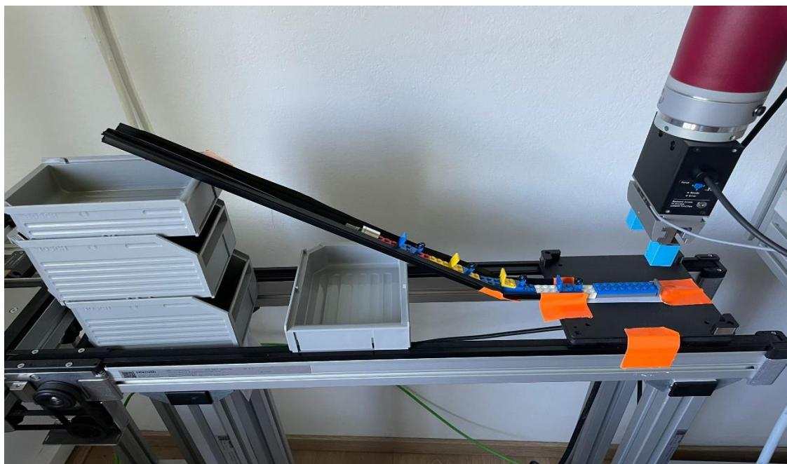
Slika 9. Izvedba improvizirane pokretne trake
