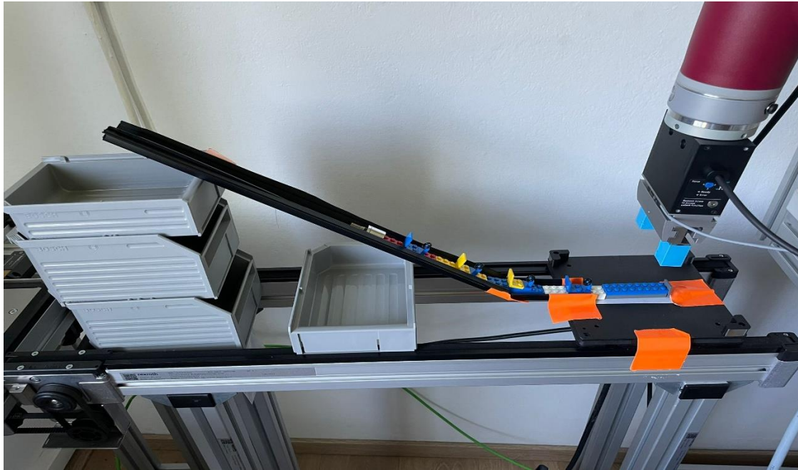
Slika 9. Izvedba improvizirane pokretne trake
