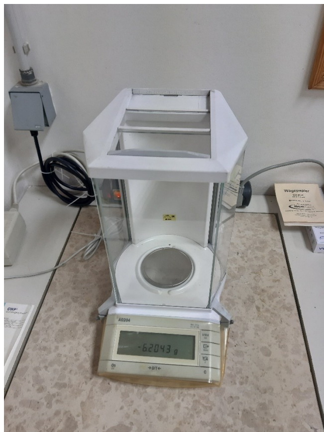
Slika 18. Precizna vaga sa zatvorenim prostorom za vaganje
