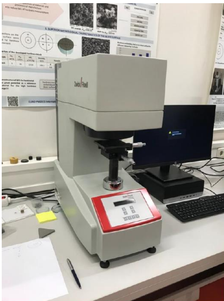
Slika 19. INDENTEC ZHV \mu tvrdomjer
