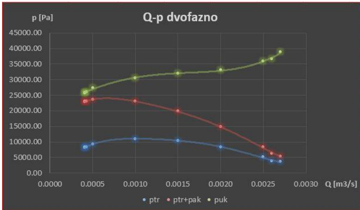
Slika 12. Utjecaj protoka na padove tlaka u grijanoj cijevi.
