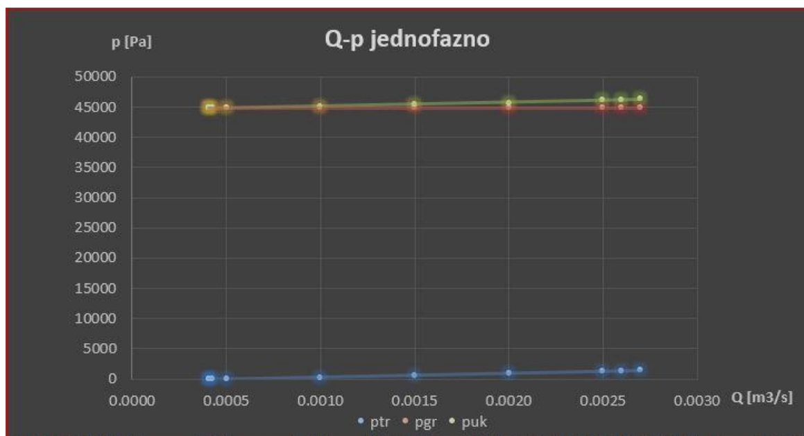
Slika 13. Utjecaj protoka na padove tlaka u jednofaznom strujanju.
