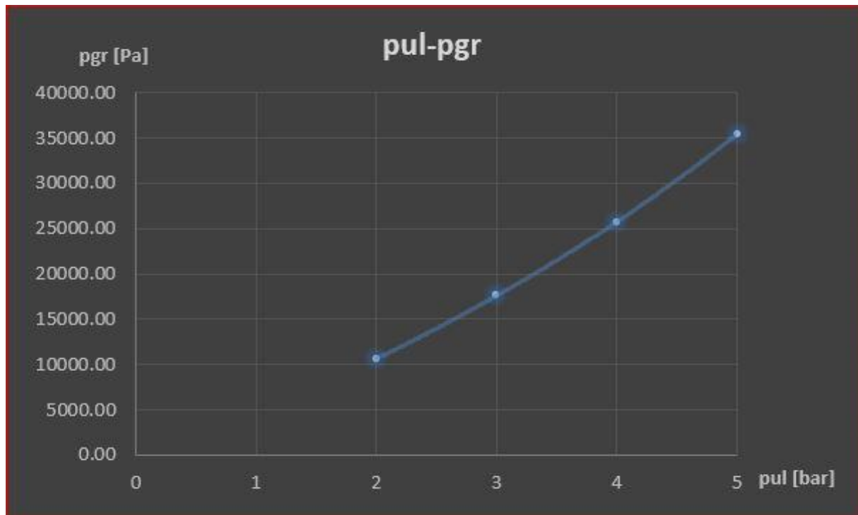
Slika 26. Ovisnost gravitacijske komponente o ulaznom tlaku.
