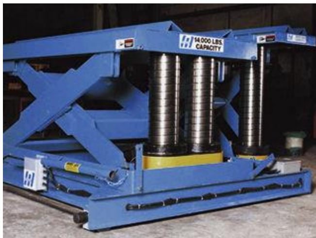
Slika 7. Podizna platforma s spiralnim vođenjem.
