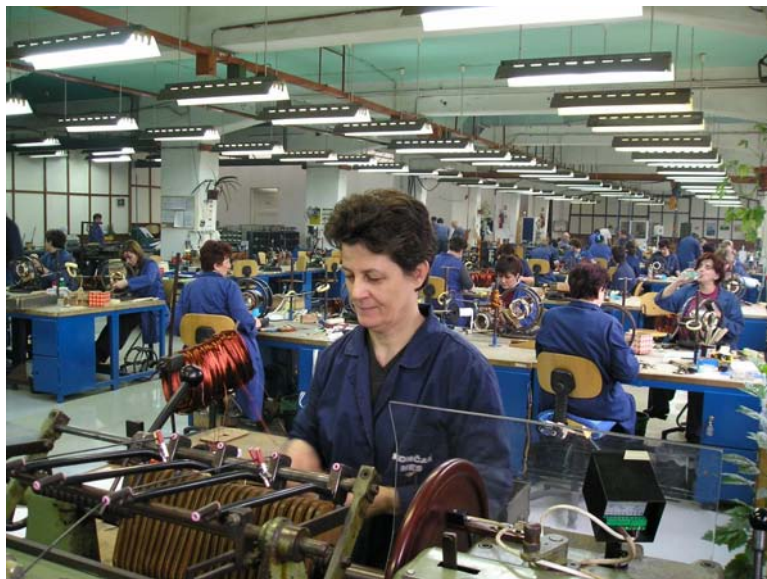
Slika 3.1 Ručno namatanje u namataonici
