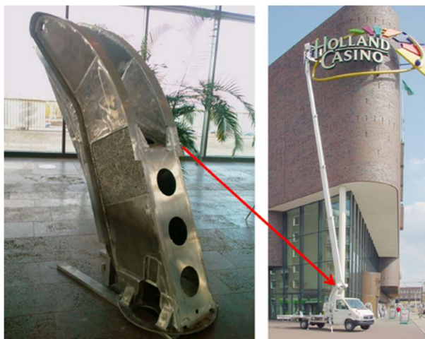
Slika 22 Nosiva greda od aluminijske pjene [14]
