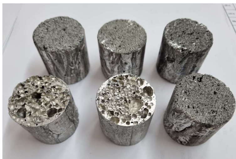
Slika 51 Uzorci aluminijevih pjena
