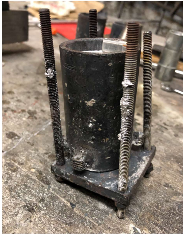
Slika 48 Kalup s prekursorom za izradu metalne pjene
