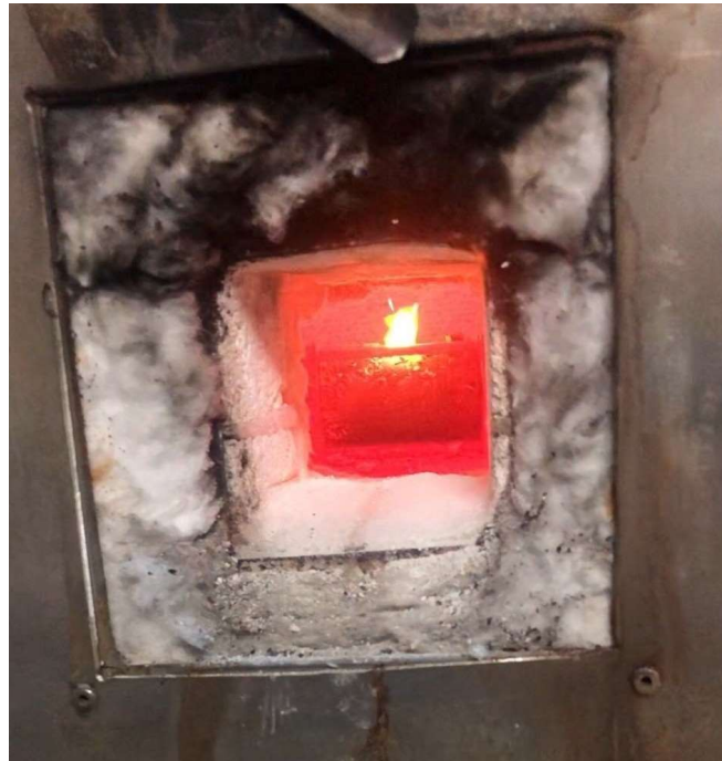
Slika 50 Izlazak pjene iz kalupa
