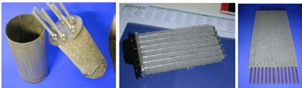
Slika 30 Različiti izmjenjivači topline od metalne pjene [14]
