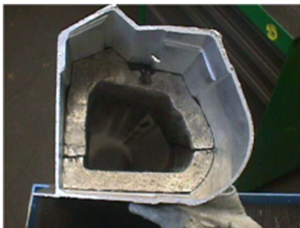
Slika 23 Prag Ferrarija ispunjen aluminijevom pjenom [14]
