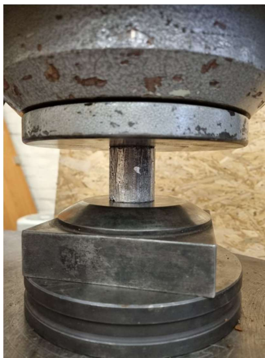
Slika 127 Tlačno ispitivanje uzorka
