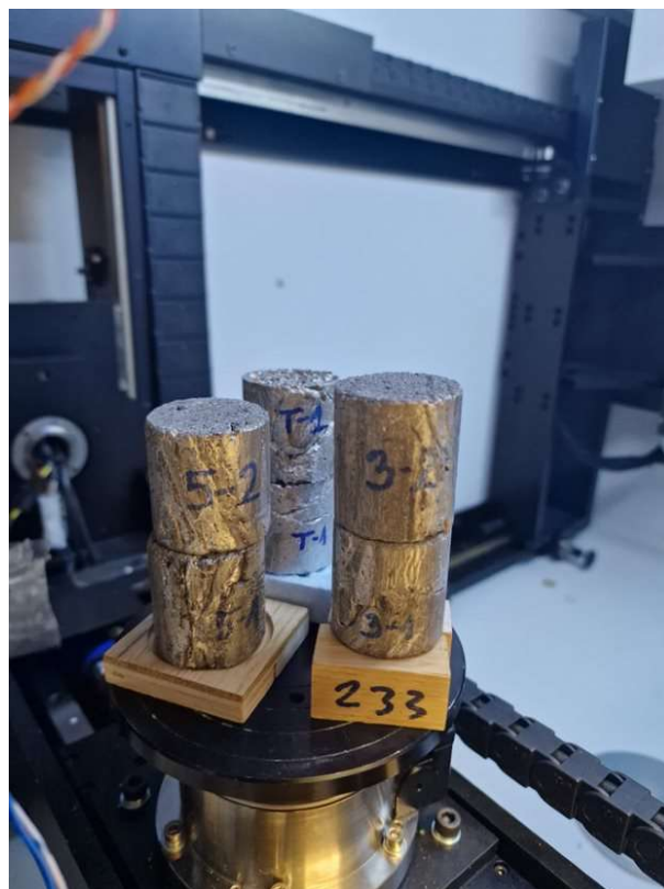
Slika 53 Položaj uzoraka u CT uređaju
