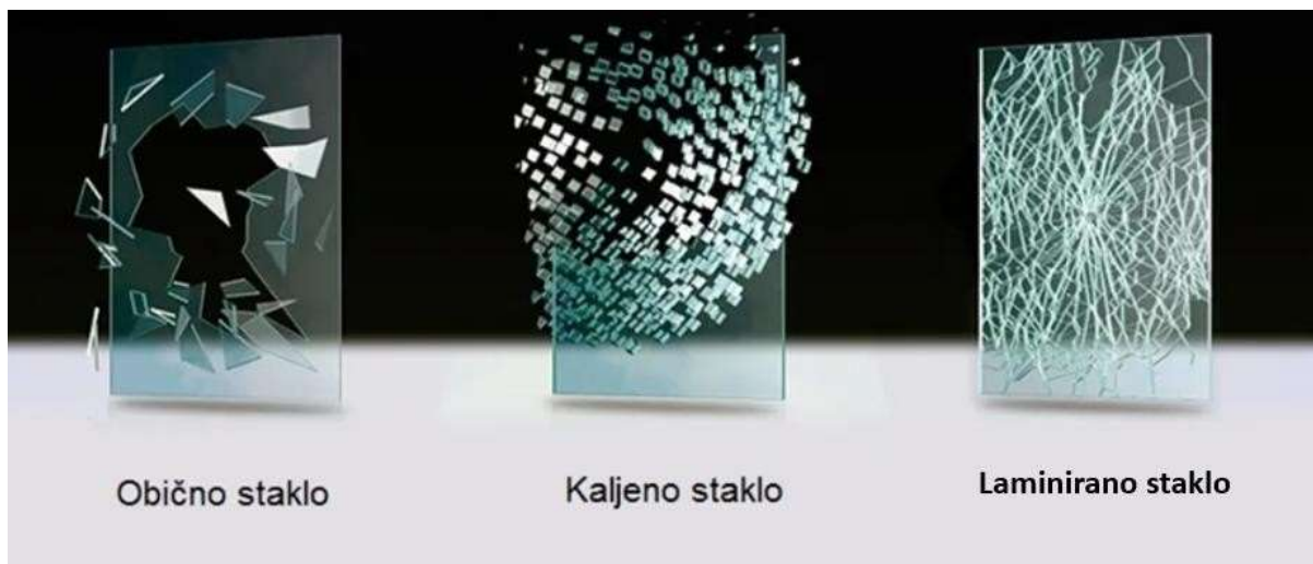
Slika 4. Izgled loma običnog, kaljenog i laminiranog stakla [27]
