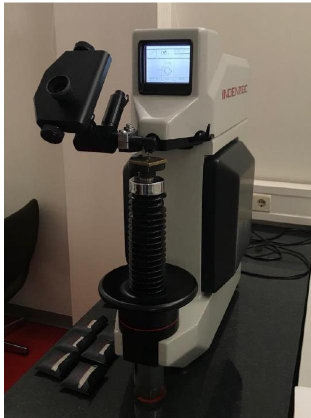
Slika 13. Tvrdomjer proizvođača Indentec 5030 TKV
