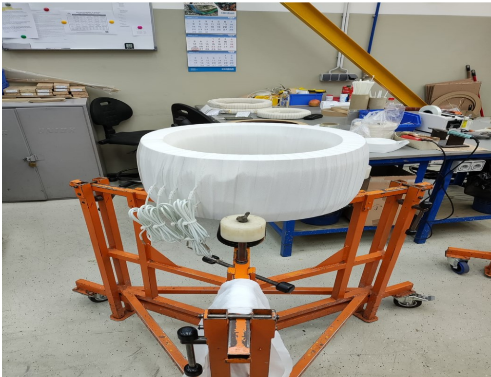
Slika 3.3 Namatanje sekundarnih namota
