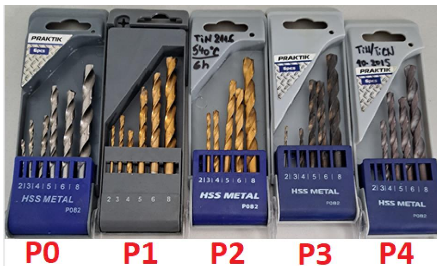
Slika 25. Svrkla u polaznom stanju prije pokusa trošenja
