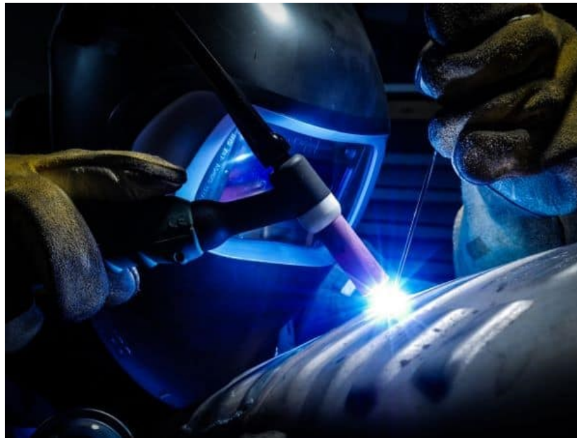
Slika 25 Zavarivanje s M1 mješavinom zaštitnog plina [38]
