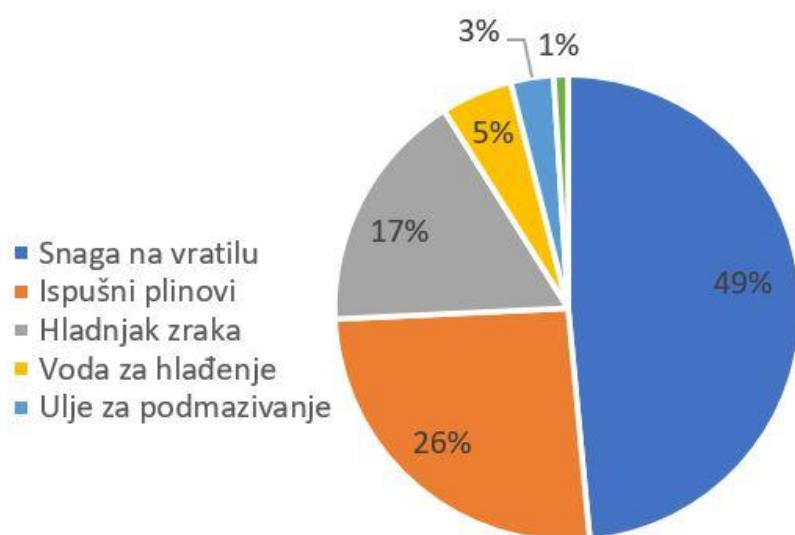
Slika 2 Distribucija energije tipičnog broskog porivnog motora [3]
