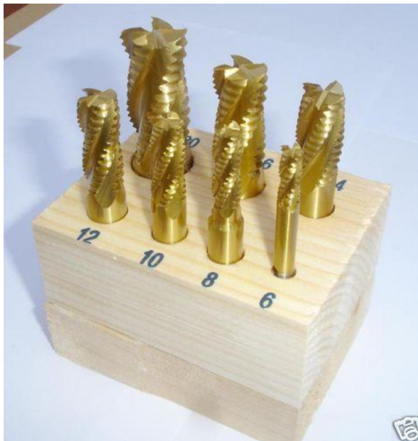
Slika 61: Set glodala izrađeni po normi DIN844 od brzoreznog čelika prevučeni TiN prevlakom
