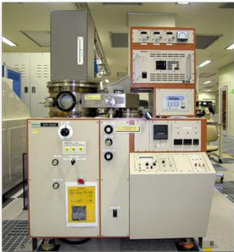
Slika 22: Uređaj za PVD postupak r-f raspršivanja materijala mete tvrtke Anelva, model SPF-332H [7]
