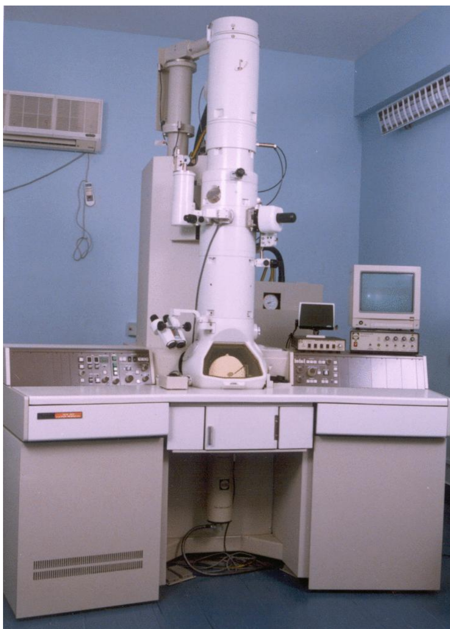
Slika 41: TEM uređaj sa vakuumskom komorom Instituta za fiziku, Indija [15]
