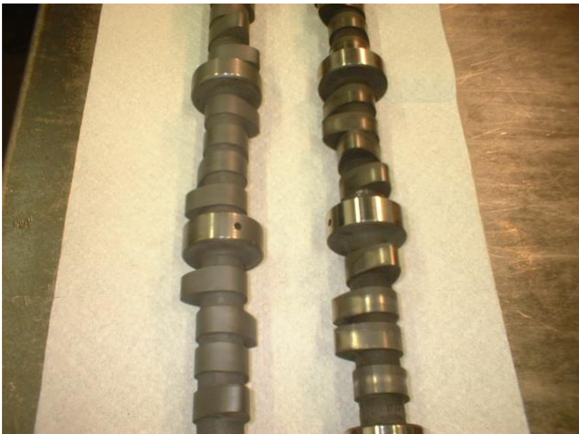
Slika 66: Bregasta osovina i-Vtec motora tvrtke Honda sa bregovima prevučenim prevlakom MoST [5]
