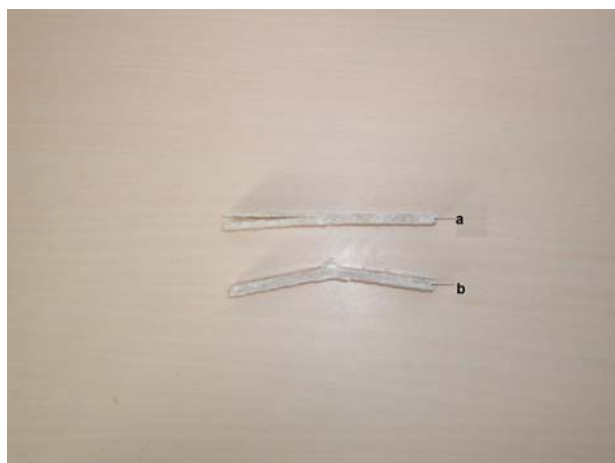
Slika 23. a-raslojavanje, b-djelomični lom
