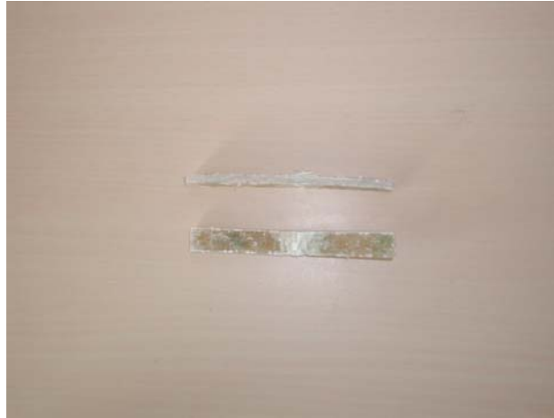
Slika 22. Djelomični lom epruveta bez zareza
