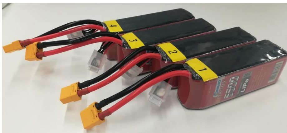
Slika 9. Akumulatorski paketi za robote
