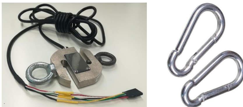
Slika 8. Bosche S40S-0075 senzor sile (lijevo) i karabineri DIN 5299 5x50 (desno)
