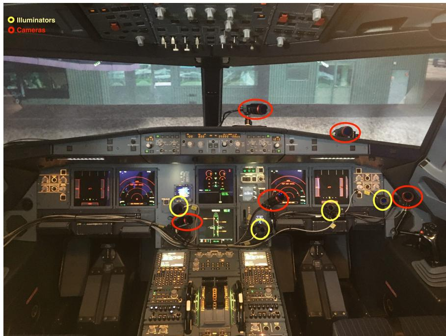
Slika 2.1: Prototipni CMS razvijen u sklopu projekta PEGGASUS, slika preuzeta s:
