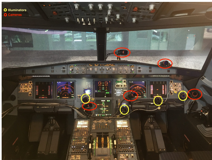
Slika 2.1: Prototipni CMS razvijen u sklopu projekta PEGGASUS, slika preuzeta s: https://www.geogaze.org/peggasus/
