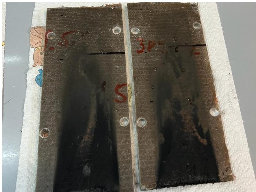
**Slika 38. Rezultati ispitivanja ispitnih tijela (kompozit 5) nakon gorenja**
