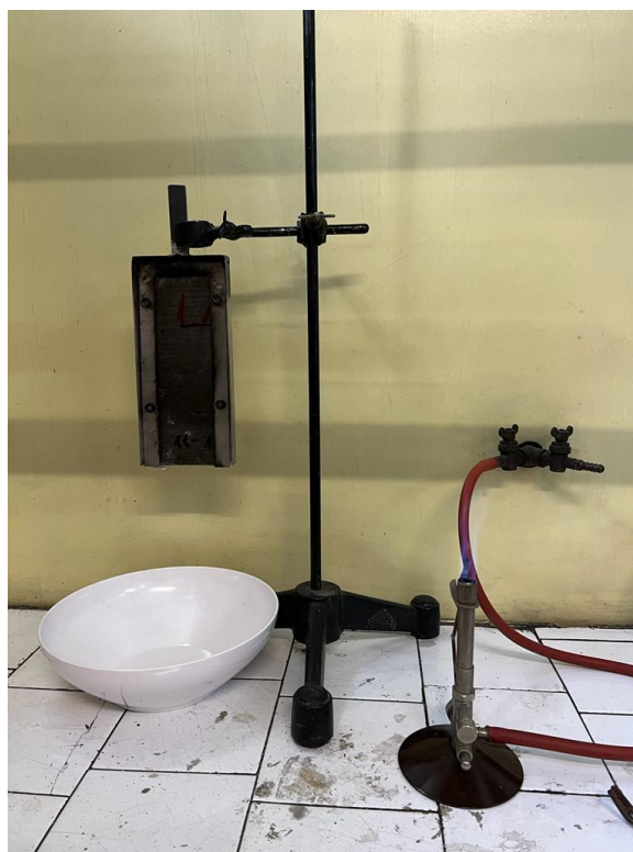
Slika 27. Plamenik i konstrukcija potrebni za ispitivanje gorivosti kompozitnih materijala
