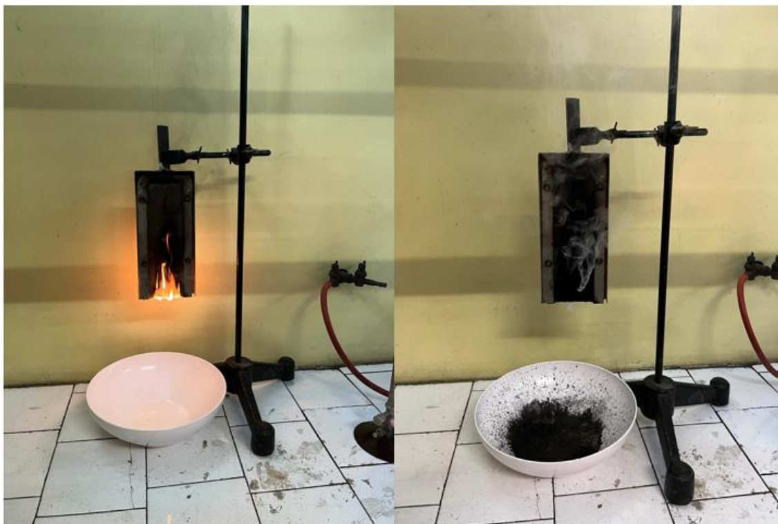
Slika 28. Prikaz hibridnog kompozita 1 (SLLLLS) tijekom gorenja i neposredno nakon gašenja
