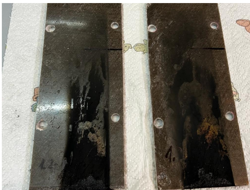
Slika 35. Rezultati ispitivanja ispitnih tijela (hibridni kompozit 2) nakon gorenja
