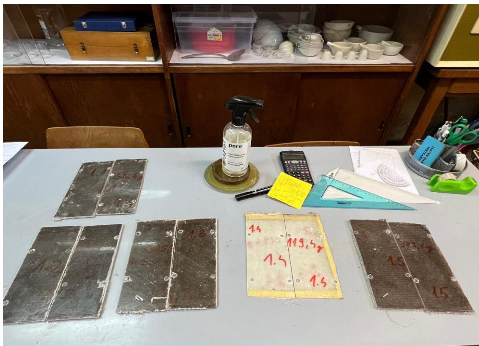
Slika 26. Pripremljena ispitna tijela za ispitivanje gorivosti kompozitnih materijala
