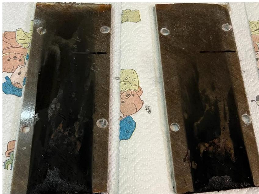
**Slika 36. Rezultati ispitivanja ispitnih tijela (hibridni kompozit 3) nakon gorenja**
