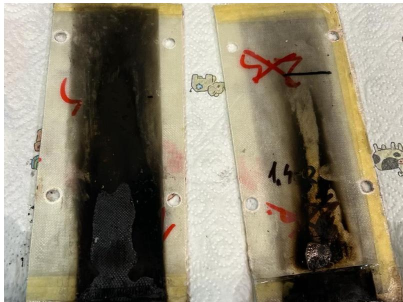
**Slika 37. Rezultati ispitivanja ispitnih tijela (kompozit 4) nakon gorenja**
