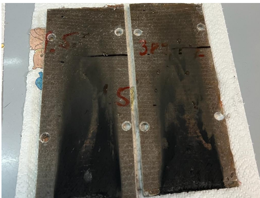
Slika 38. Rezultati ispitivanja ispitnih tijela (kompozit 5) nakon gorenja
