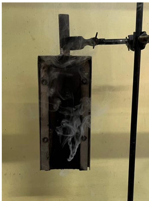
Slika 34. Ispitno tijelo 1 (hibridni kompozit 1) neposredno nakon gašenja
