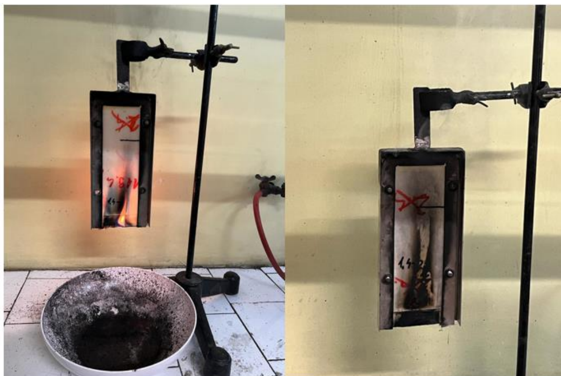
Slika 29. Prikaz kompozita 4 (SSSSSS) tijekom gorenja i neposredno nakon gašenja
