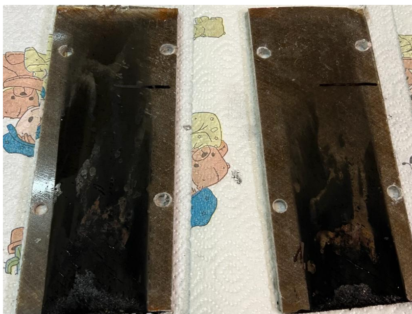
Slika 36. Rezultati ispitivanja ispitnih tijela (hibridni kompozit 3) nakon gorenja
