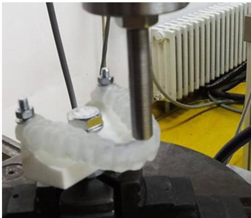
Slika 6.8. Eksperimentalni postav 1 ugraden na radni stol kidalice
