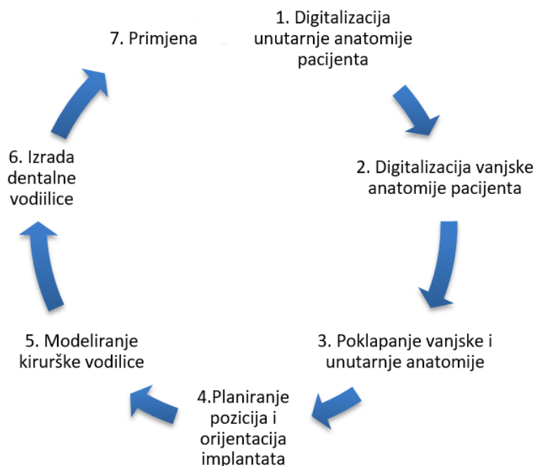
Slika 1.3. Proces izrade dentalnih vodilica za postavljanje implantata
