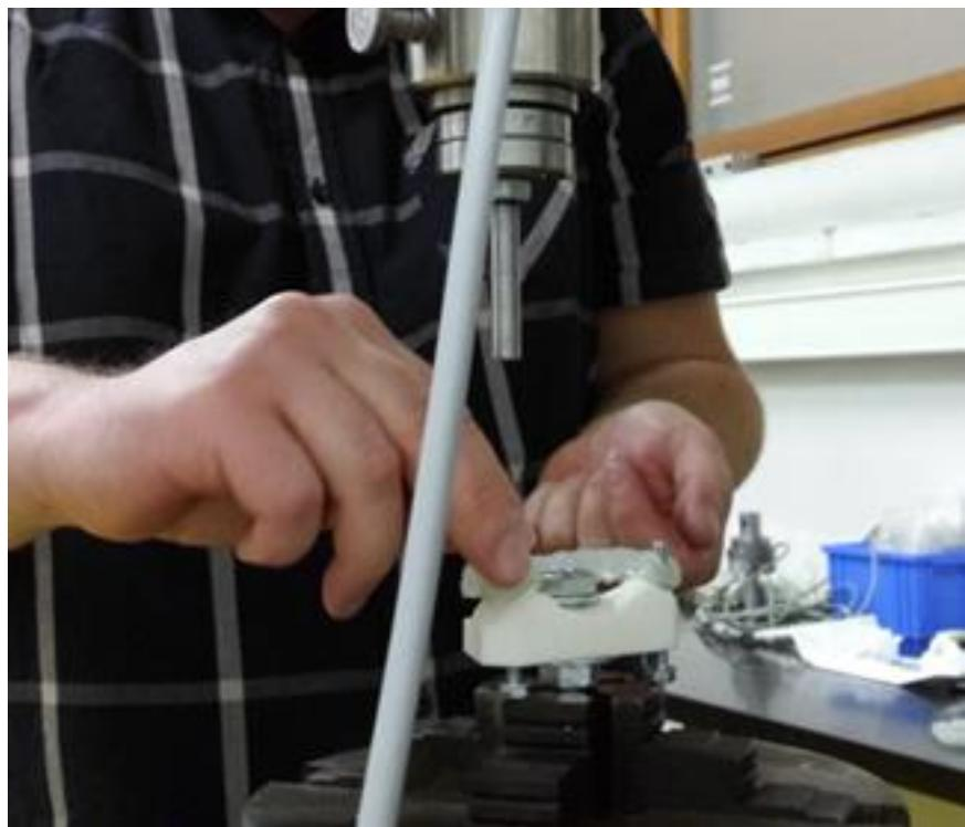
Slika 6.7. Montaža eksperimentalnog postava na radni stol kidalice
