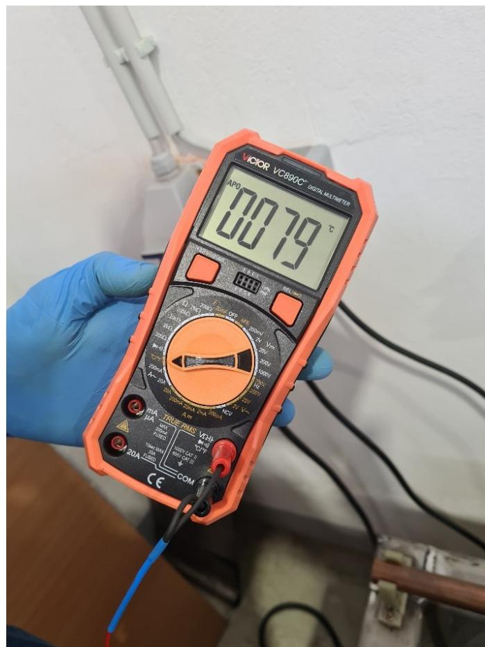
**Slika 14.** Vrijednost temperature elektrolita izmjerena kontaktnim mjeračem temperature
