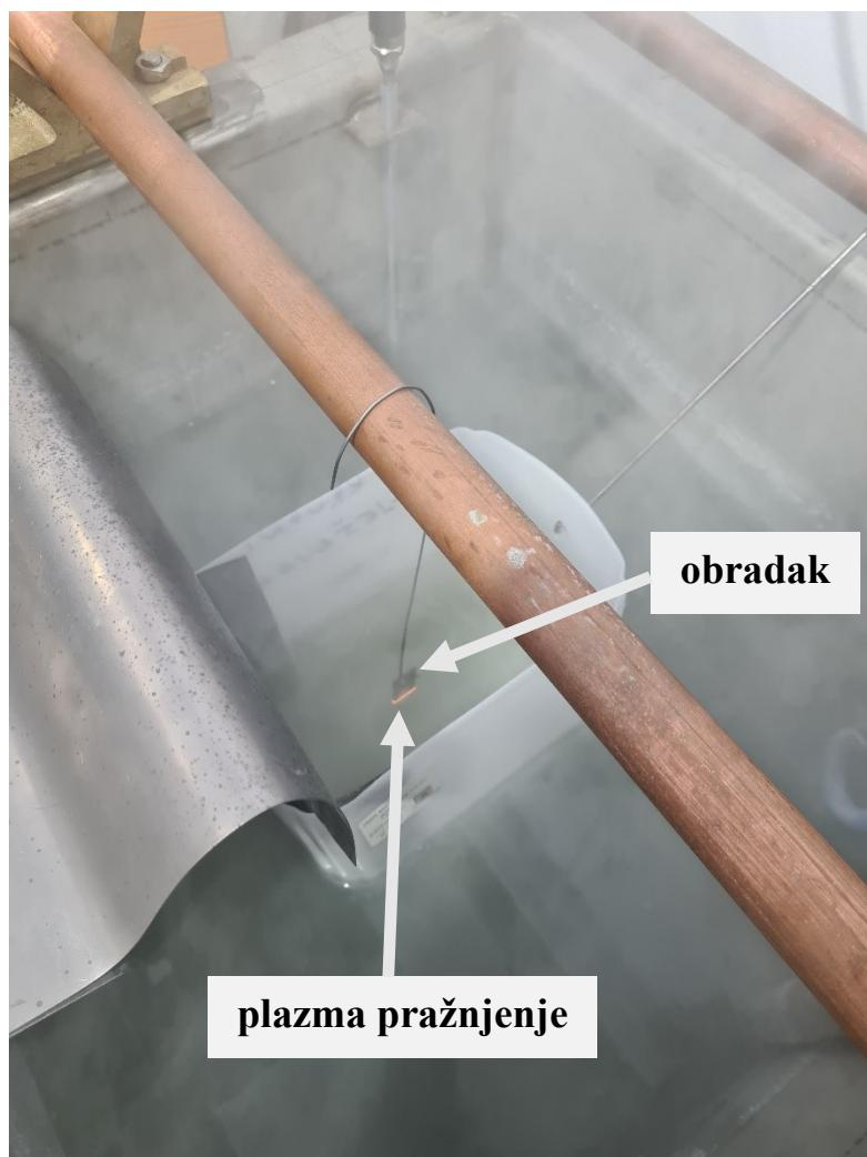
**Slika 16. Postupak elektrolitičkog-plazma poliranja**
