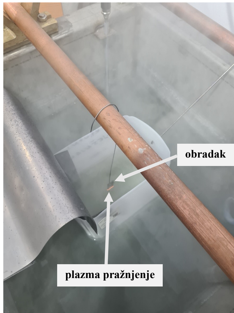
Slika 16. Postupak elektrolitičkog-plazma poliranja
