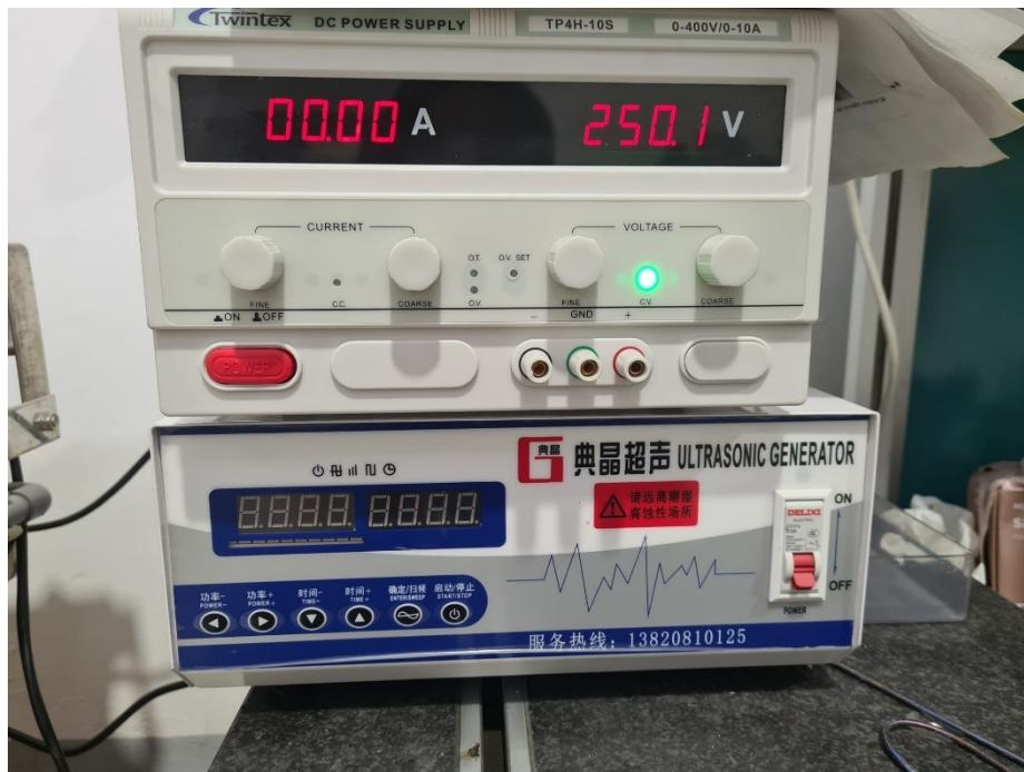
**Slika 13.** Dijelovi uređaja za provedbu postupka elektrolitičkog-plazma poliranja – izvor električne struje i ultrazvuk
