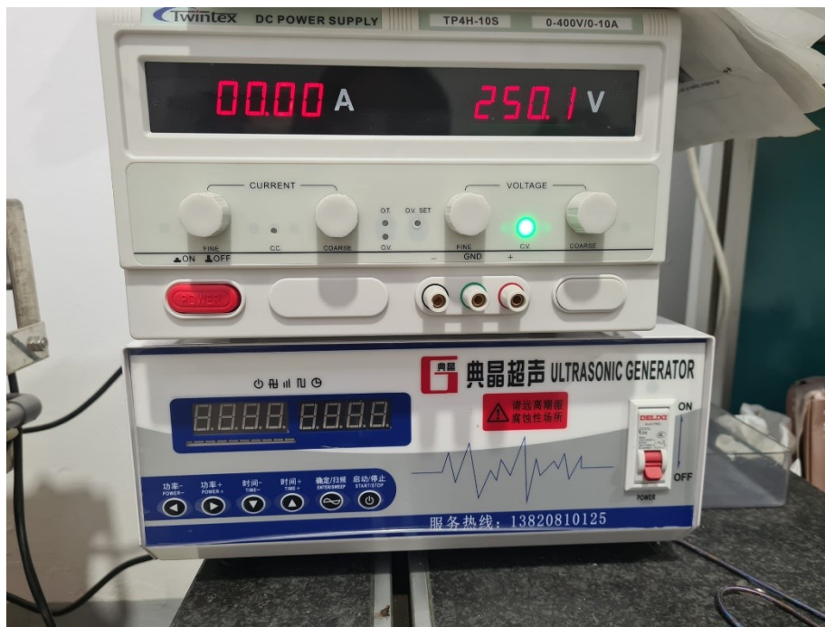
Slika 13. Dijelovi uređaja za provedbu postupka elektrolitičkog-plazma poliranja – izvor električne struje i ultrazvuk
