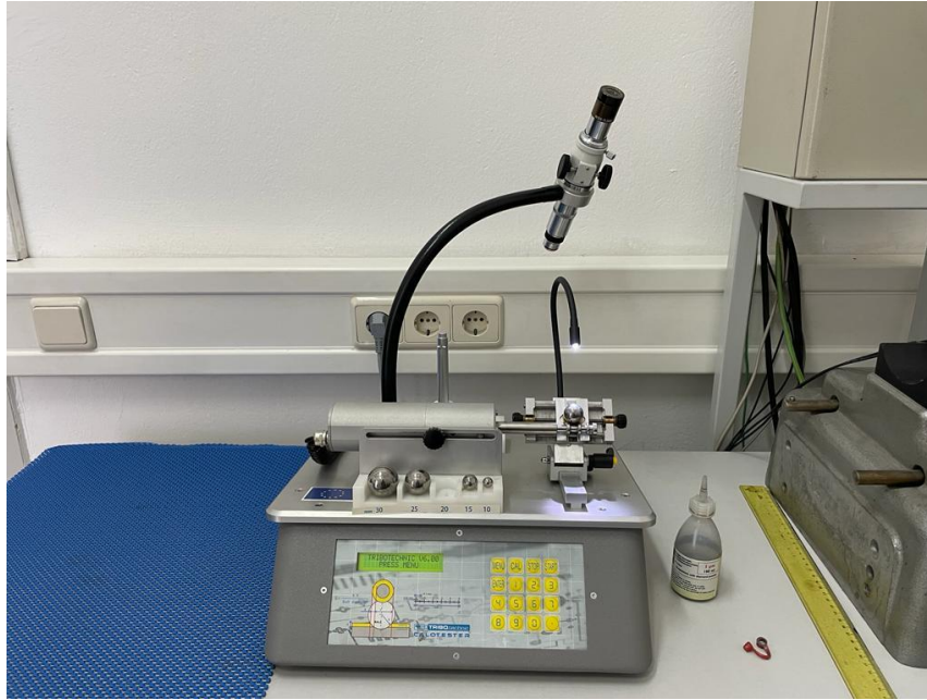
Slika 6.3 Kalotest TRIBOtechnic u Laboratoriju za inženjerstvo površina
