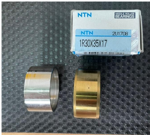
Slika 5.2 Prsteni izrađeni od legure Ti6Al4V (lijevo) i čelika 100Cr6 s prevlakom PACVD TiN (desno) korišteni za ispitivanja trenja
