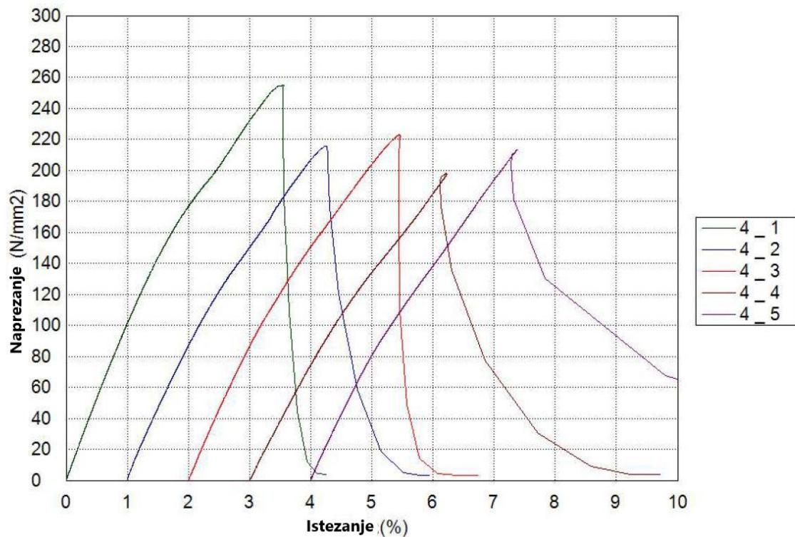
Slika 25. Dijagram rasteznoga naprezanja – istezanja za SSSSS konfiguraciju materijala
