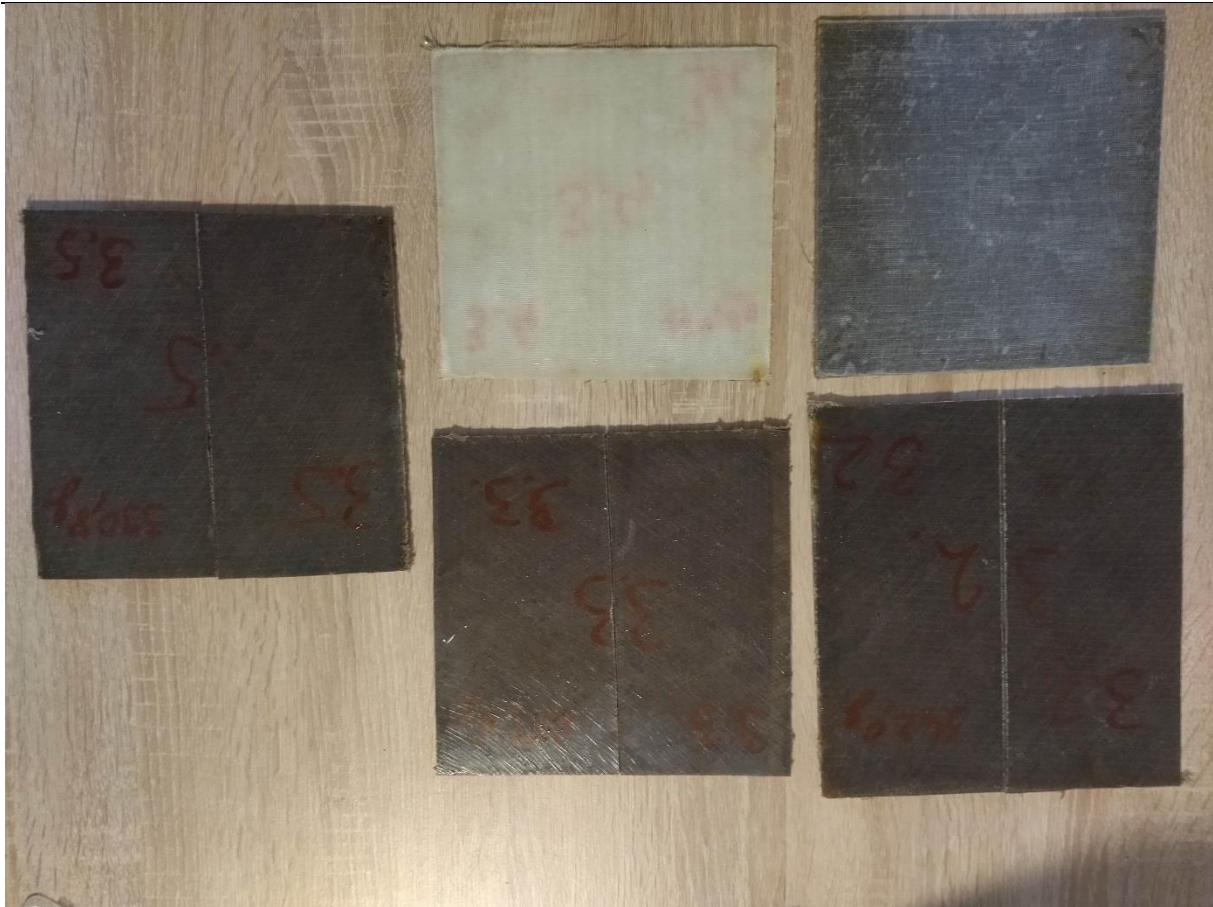
**Slika 10. Prikaz uzoraka za ispitivanje upojnosti**
