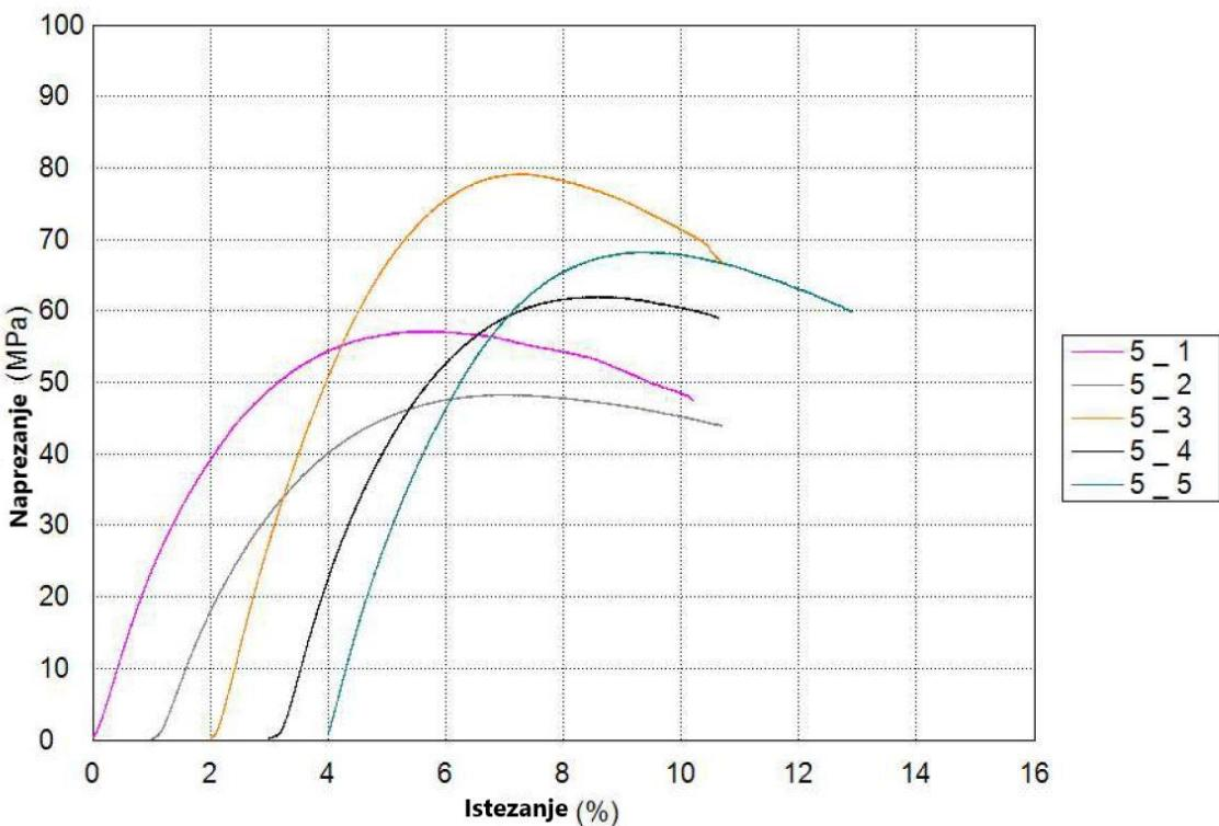
Slika 34. Dijagram savojnoga naprezanja – istezanja za LLLLLL konfiguraciju materijala
