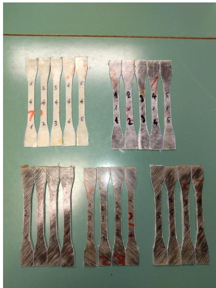
Slika 19. Ispitna tijela za rastezno ispitivanje
