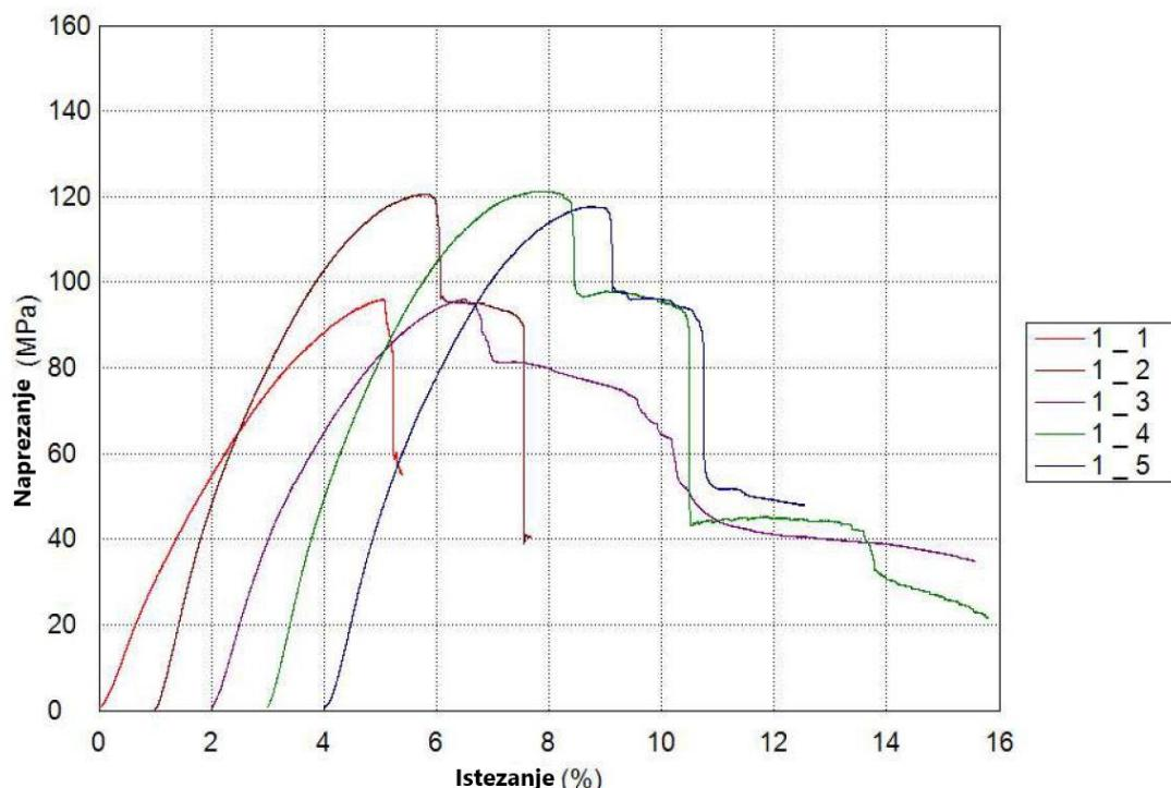
**Slika 30. Dijagram savojnoga naprezanja – istezanja za SLSSSS konfiguraciju materijala**
