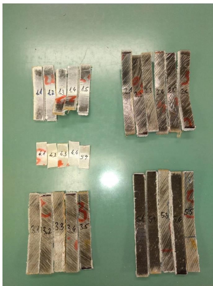
**Slika 29. Prikaz ispitnih tijela nakon savojnog ispitivanja**
