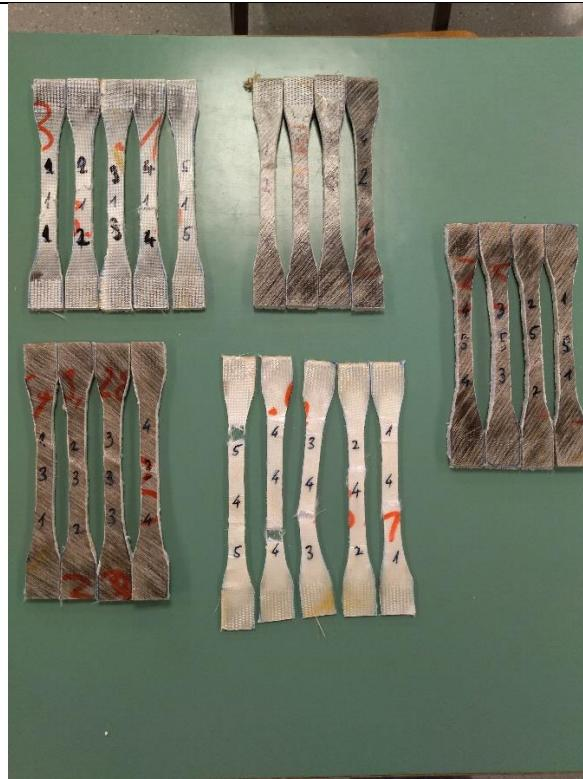
**Slika 21. Prikaz ispitnih tijela nakon rasteznog ispitivanja**
