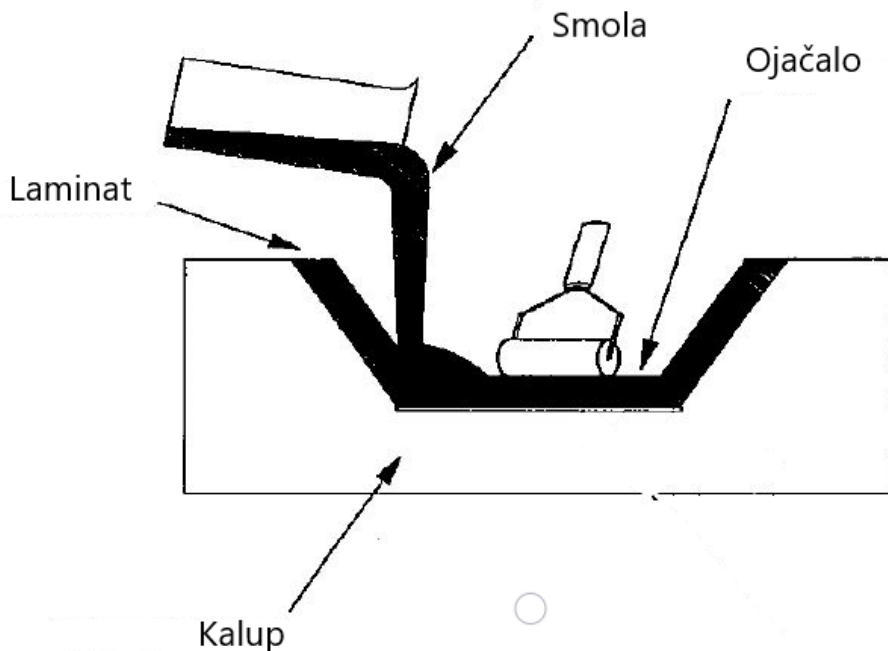
**Slika 2. Prikaz postupka ručnoga laminiranja [1]**
