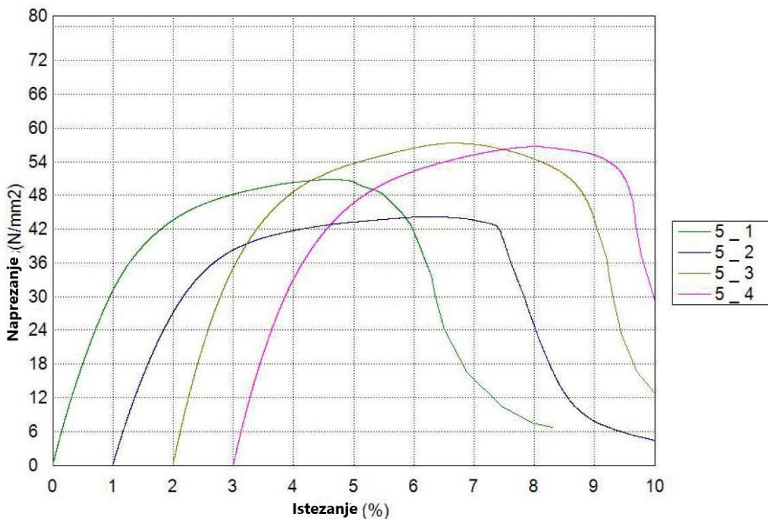
Slika 26. Dijagram rasteznoga naprezanja – istezanja za LLLLL konfiguraciju materijala
