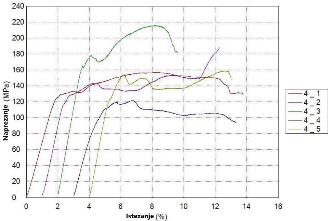
Slika 33. Dijagram savojnoga naprezanja – istezanja za SSSSS konfiguraciju materijala
