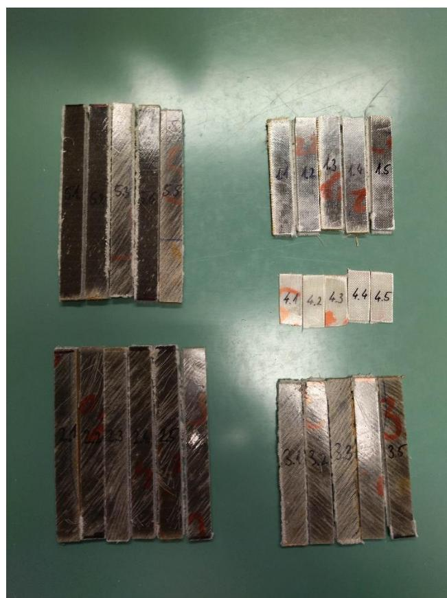
Slika 27. Prikaz ispitnih tijela za savojno ispitivanje
