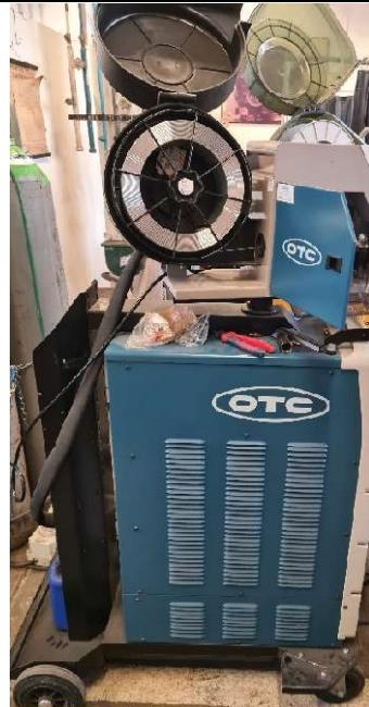
Slika 23. Welbee Inverter W400 s dodatnim materijalom
