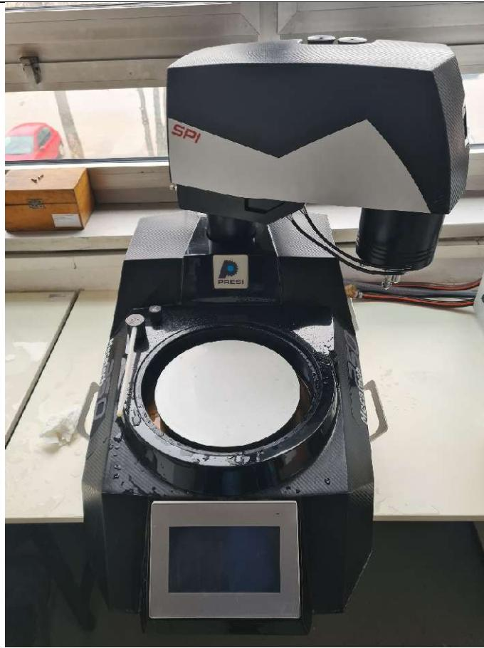
**Slika 25. Mecatech 250, stroj za poliranje**
