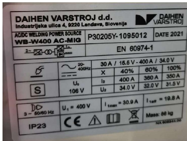
Slika 24. Karakteristike izvora struje Welbee Inverter W400
