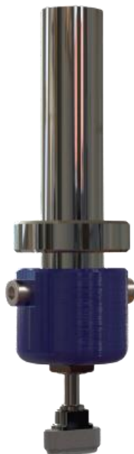
Slika 27. CAD model prihvatnice vakuumske hvataljke
