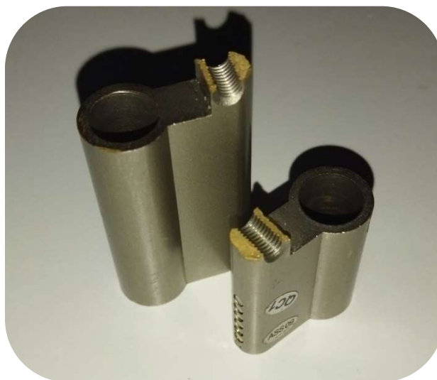
Slika 12.1 - Euro-cilindar nakon napada lomljenjem
