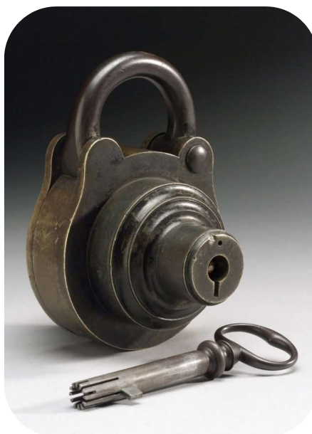
Slika 2.6 - Braham-ova cjevasta polužna brava na lokotu, ~1790.g [06]
