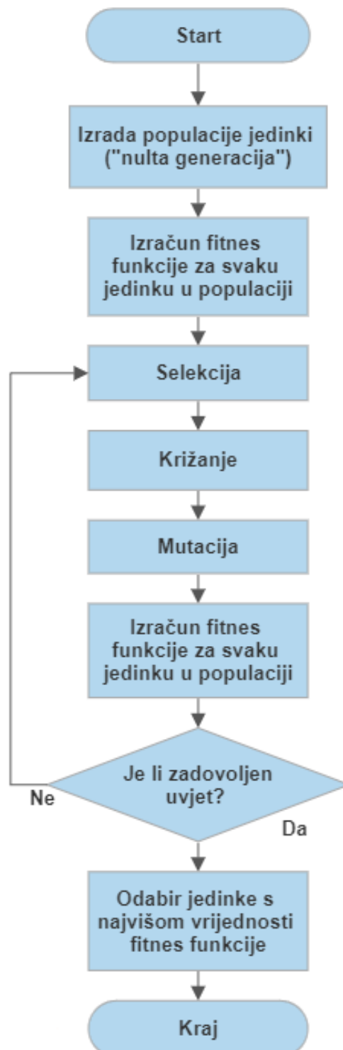
Slika 3.6: Dijagram toka genetskog algoritma
