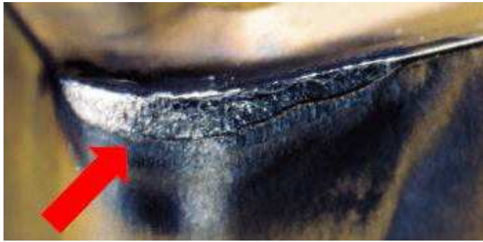
Slika 10. Trošenje na stražnjoj površini alata [3]
