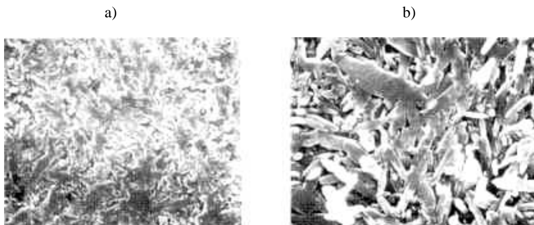
Slika 22. Mikrostruktura \text{Si}_3\text{N}_4 + \text{Al}_2\text{O}_3, \text{Y}_2\text{O}_3 vruće prešanog pri: a) 90min, b) 400min [4]
