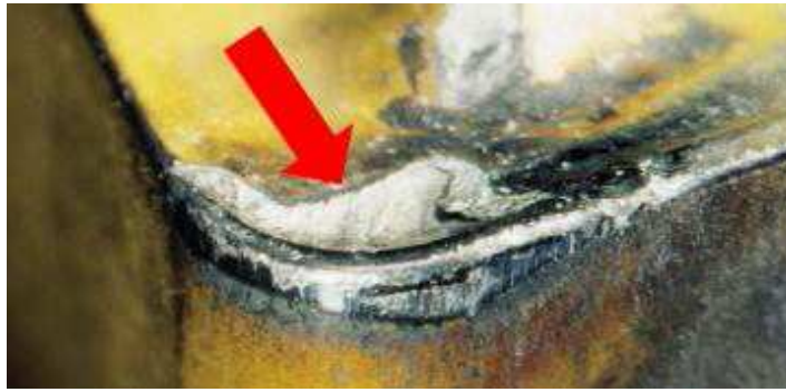
Slika 9. Krater na reznjoj pločici [3]
