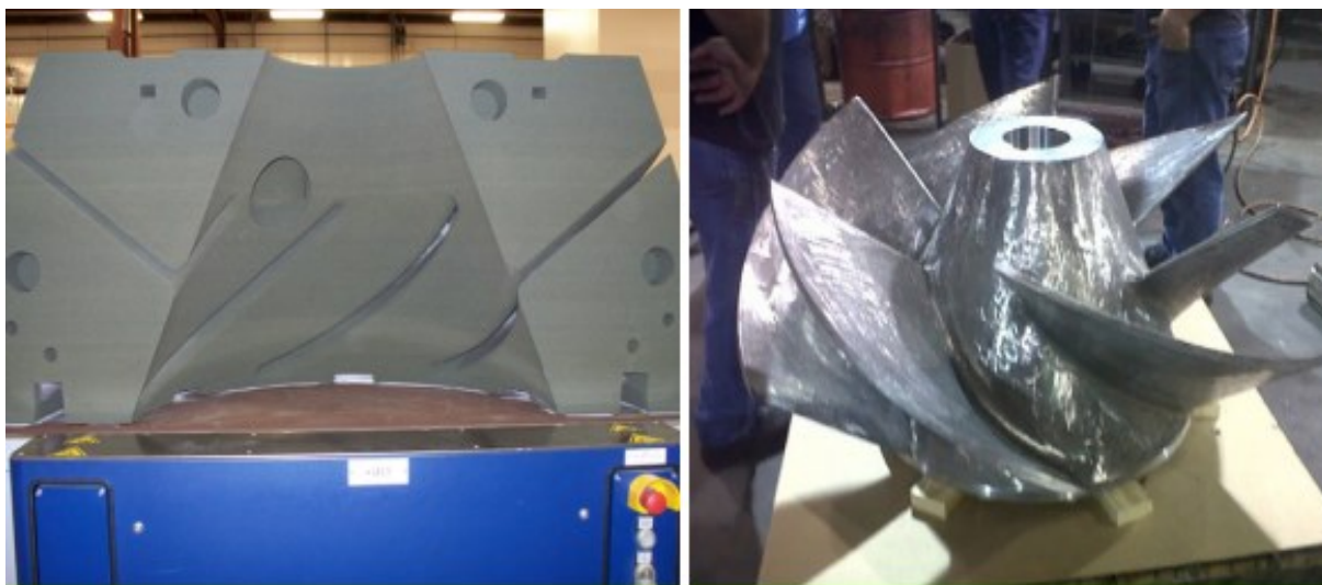
Slika 30. Jezgra dobivena aditivnom proizvodnjom (lijevo); gotovi odljevak (desno) [22]
