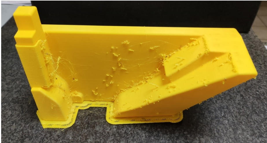
Slika 40. Ispisani model izvađen iz pisača
