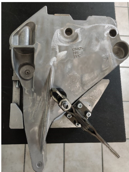
Slika 69. Provjera nalijeganja nosača motora na napravu
