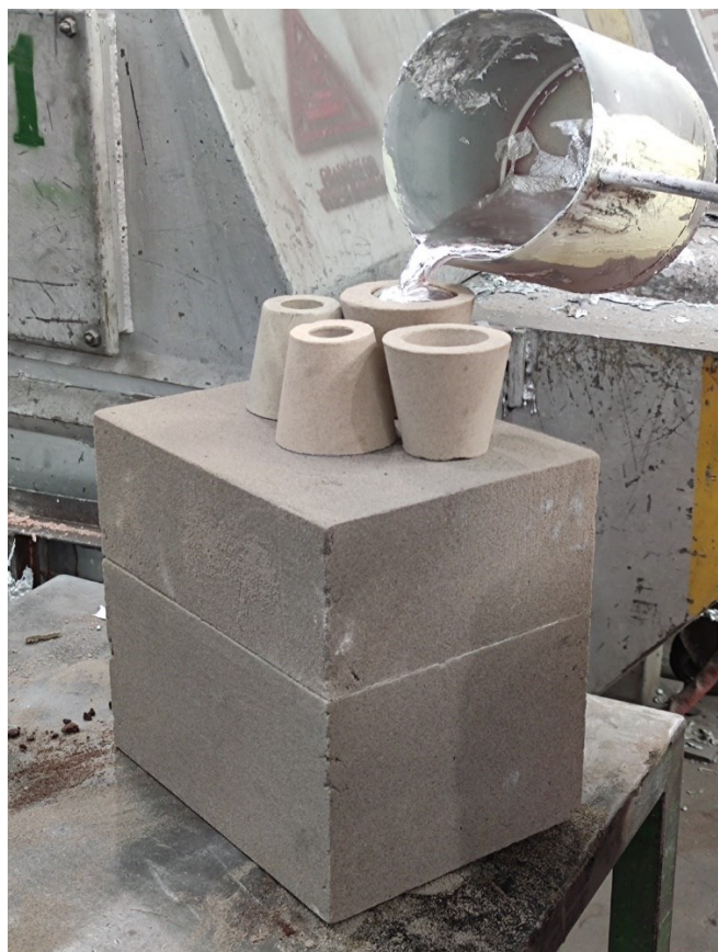
Slika 62. Lijevanje u kalup
