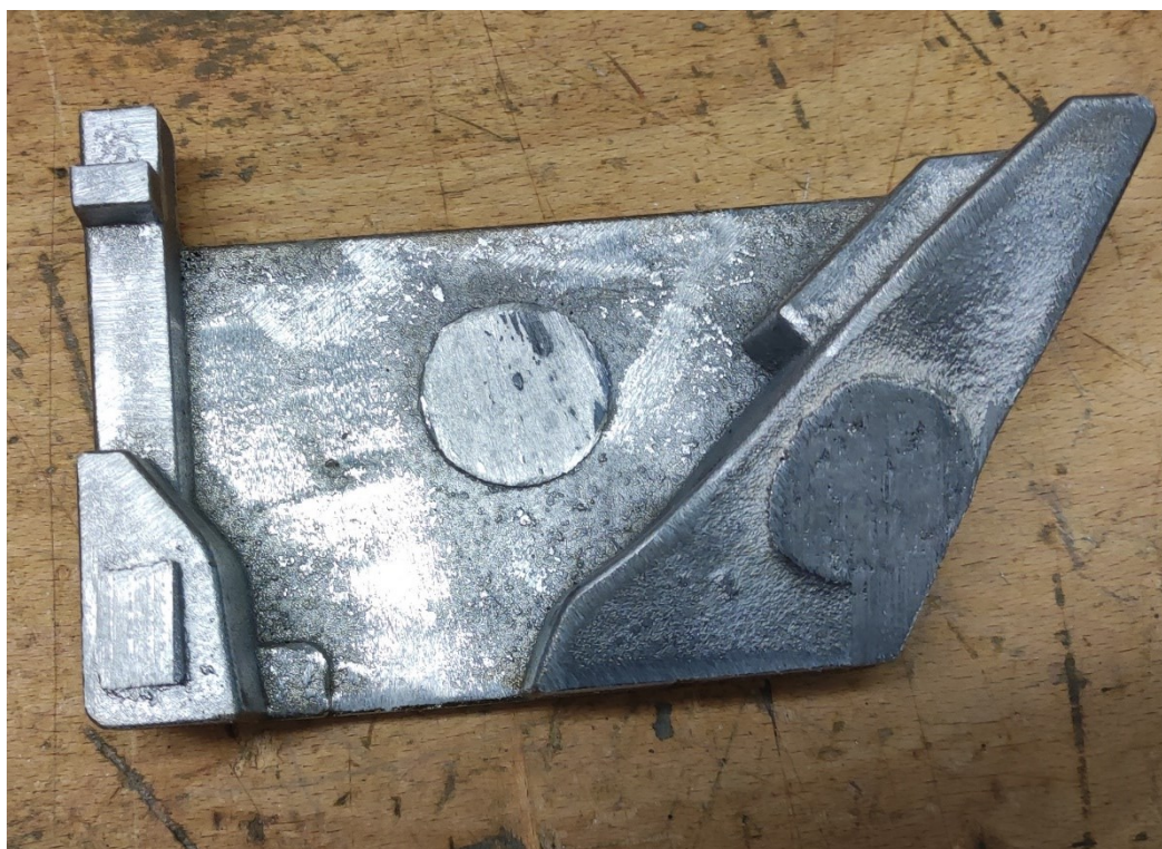
Slika 64. Naprava nakon vadenja iz kalupa i uklanjanja uljavnog sustava
