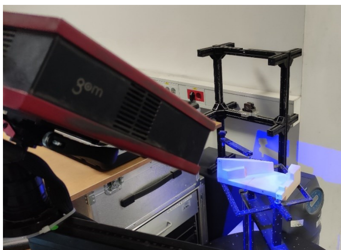
Slika 45. Proces 3D skeniranja modela
