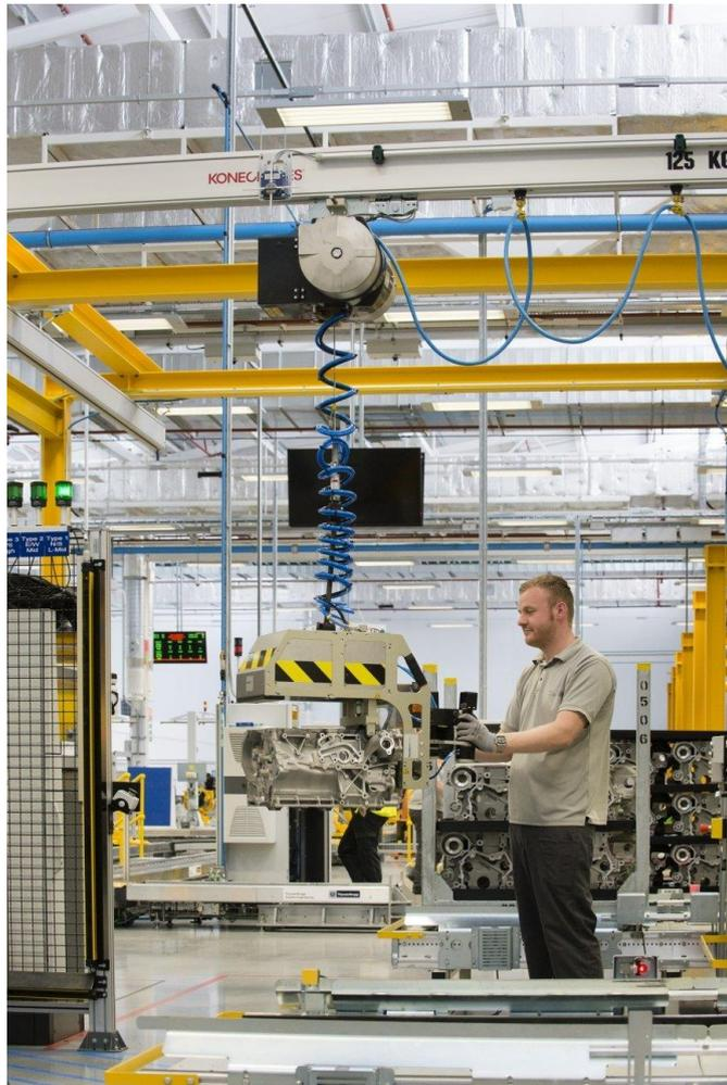
*Slika 8. Radnik koji diže blok motora balanserom [20]*
