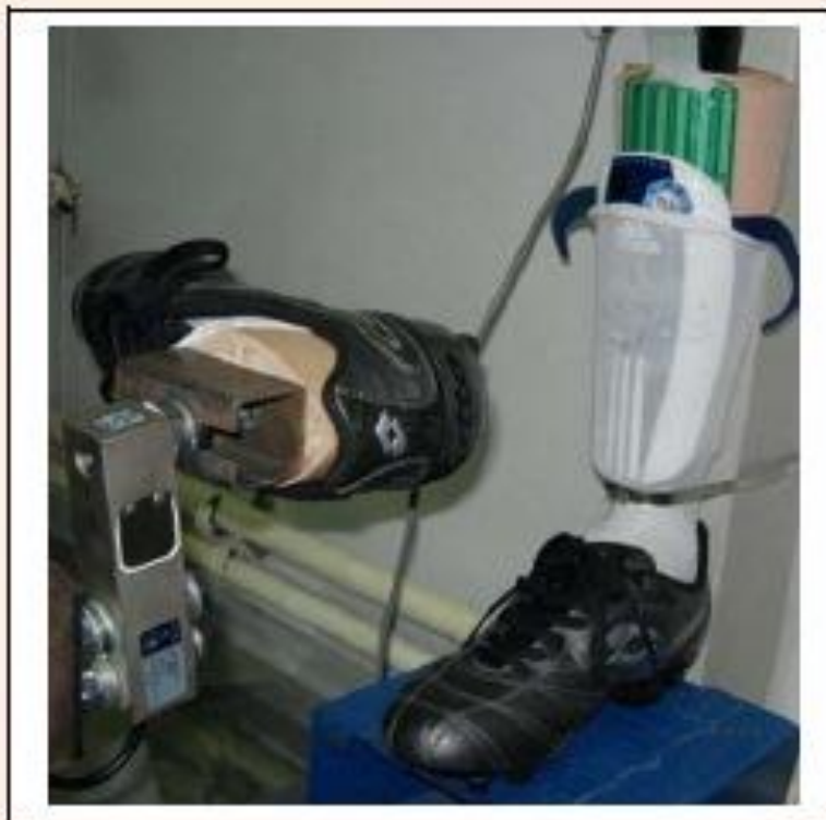
Slika 9. Eksperiment prodora tijekom udara s kopačkom [12]
