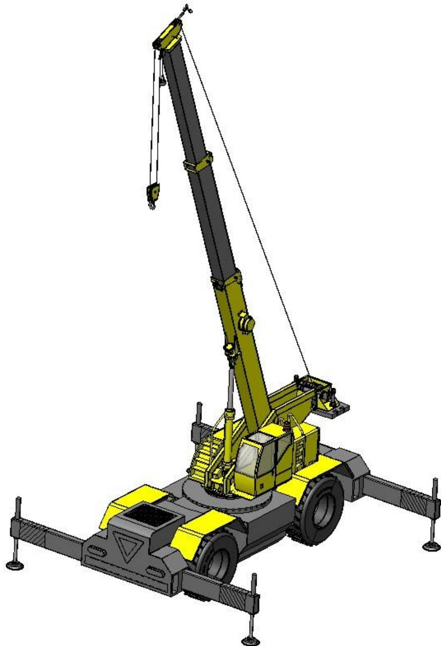
**Slika 81. Mobilni teleskopski dohvatznik – završni 3D CAD model**
