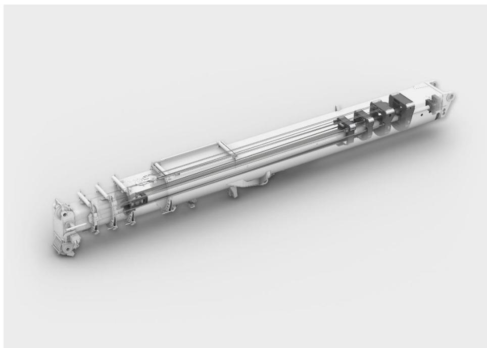
Slika 4. Liebherr LTC 1050-3.1 hidromehanički pogon dohvavnika
