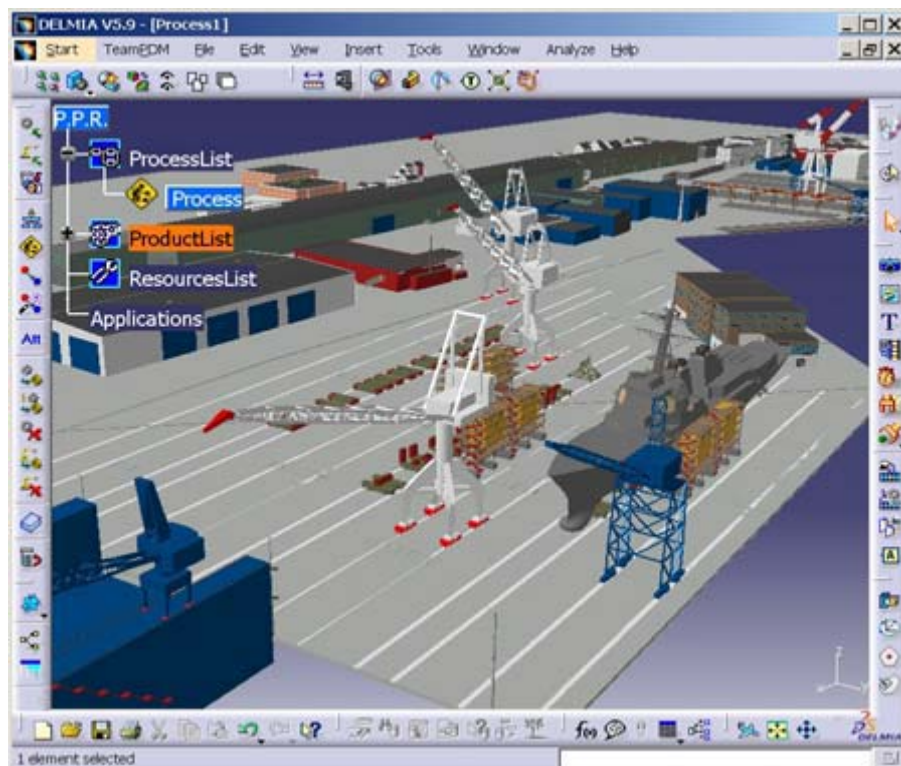
Slika 43 3D prikaz nakon definiranja rasporeda resursa u brodogradilištu [14]
