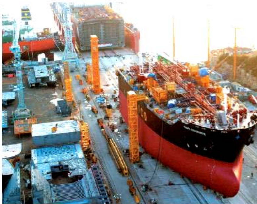
Slika 6 Transport pramčanog dijela broda na baržu pomoću hidrauličkog transportera
