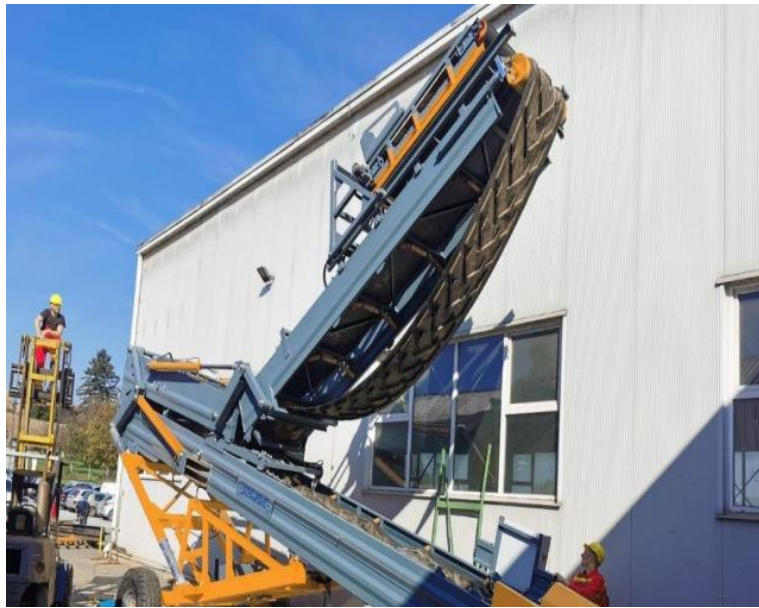
Slika 8. Preklopni konvejer s gumenom trakom [8]
