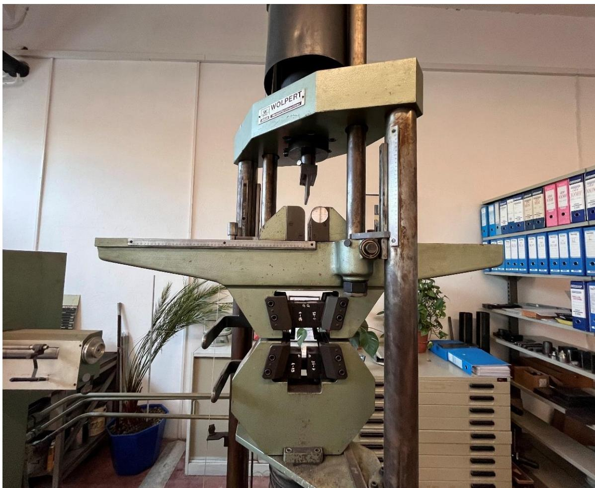
Slika 21. Kidalica prilagođena za savojno ispitivanje
