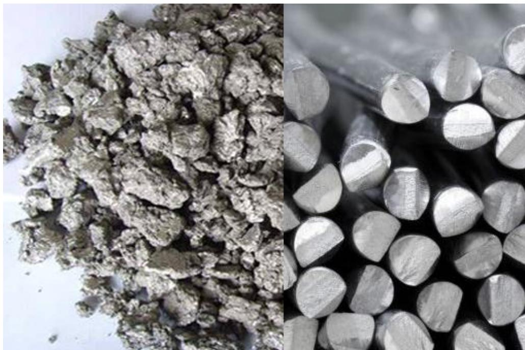
Slika 1. Titanijeva spužva i profili od titanijeve legure [3]
