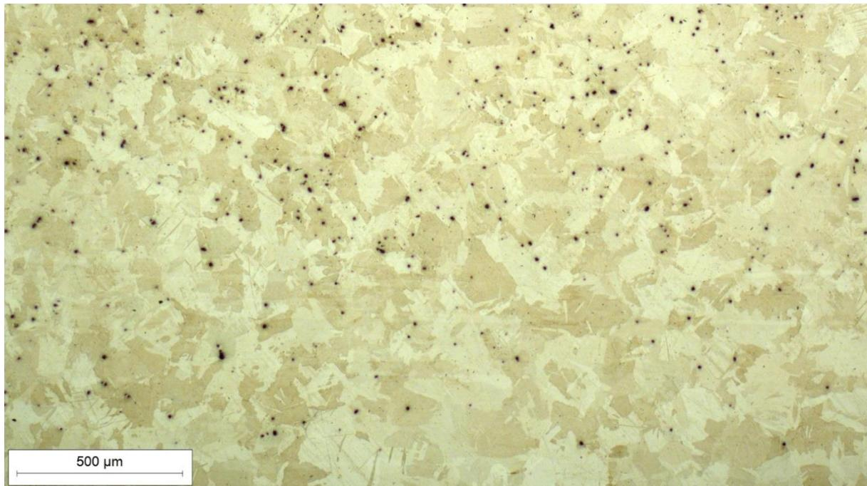
Slika 39. Mikrostruktura niskotemperaturnog ZUT-a u sredini zavara, snimljeno pri povećanju  $50\times$
