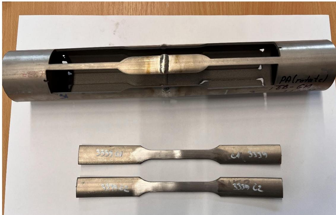
Slika 26. Ispitni uzorci za ispitivanje vlačne čvrstoće
