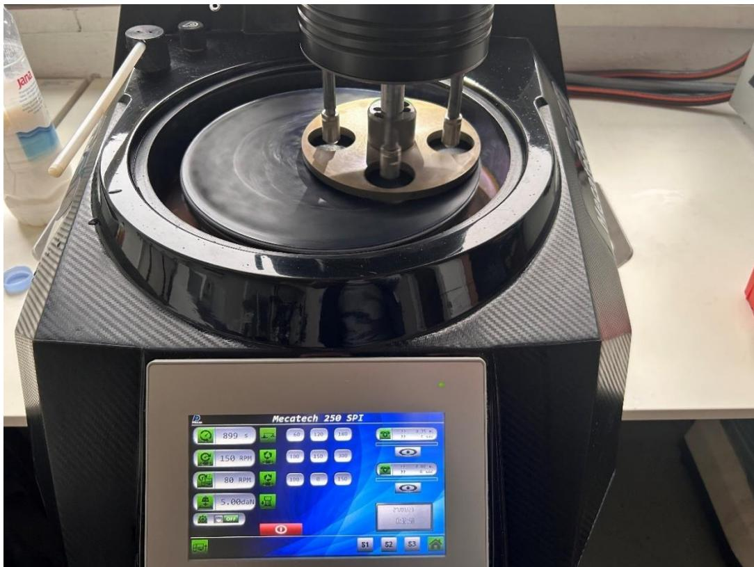
Slika 32. Postupak brušenja uzorka na uređaju Mecatech 250 SPI
