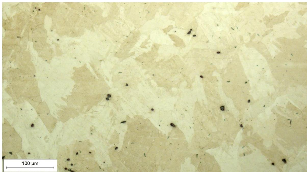
Slika 40. Mikrostruktura niskotemperaturnog ZUT-a u sredini zavara, snimljeno pri povećanju  $200\times$
