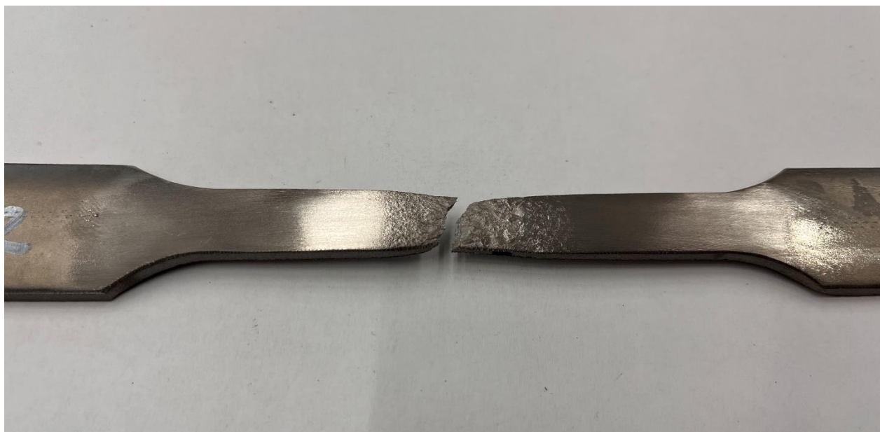
Slika 28. Slomljeni ispitni uzorak nakon statičkog vlačnog ispitivanja
