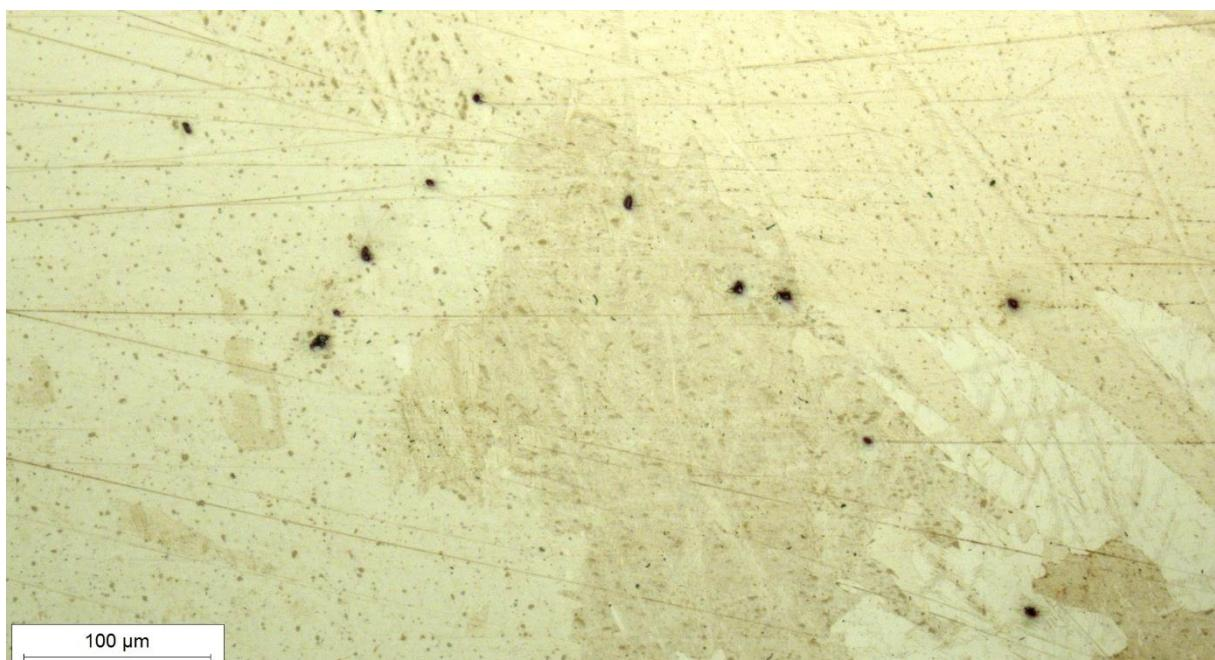
**Slika 42.** Mikrostruktura ZUT-a u sredini zavara, lijevo, snimljeno pri povećanju  $200\times$
