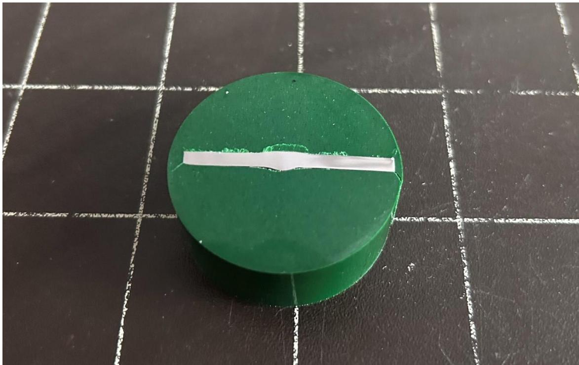
**Slika 33. Uzorak zavarenog spoja u poliranom stanju**
