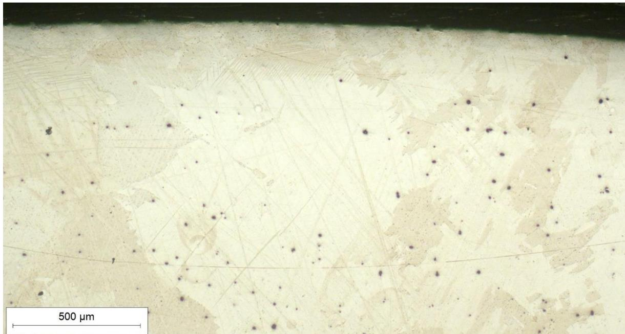
**Slika 43.** Mikrostruktura metala zavara u tjemenu, snimljeno pri povećanju  $50\times$
