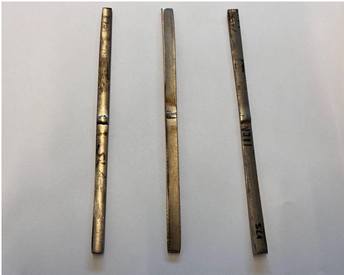
**Slika 22.      Pripremljeni uzorci za savojno ispitivanje**
