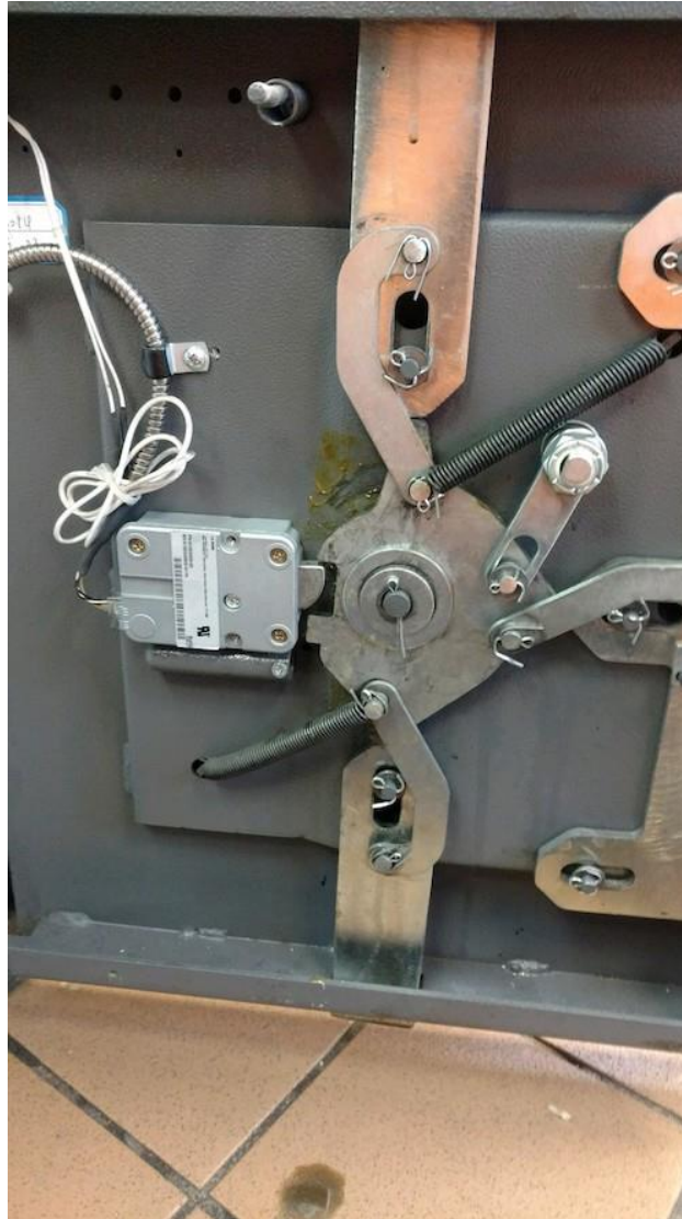
Slika 3.4 Pokretanje zasuna preko zglobova [17]
