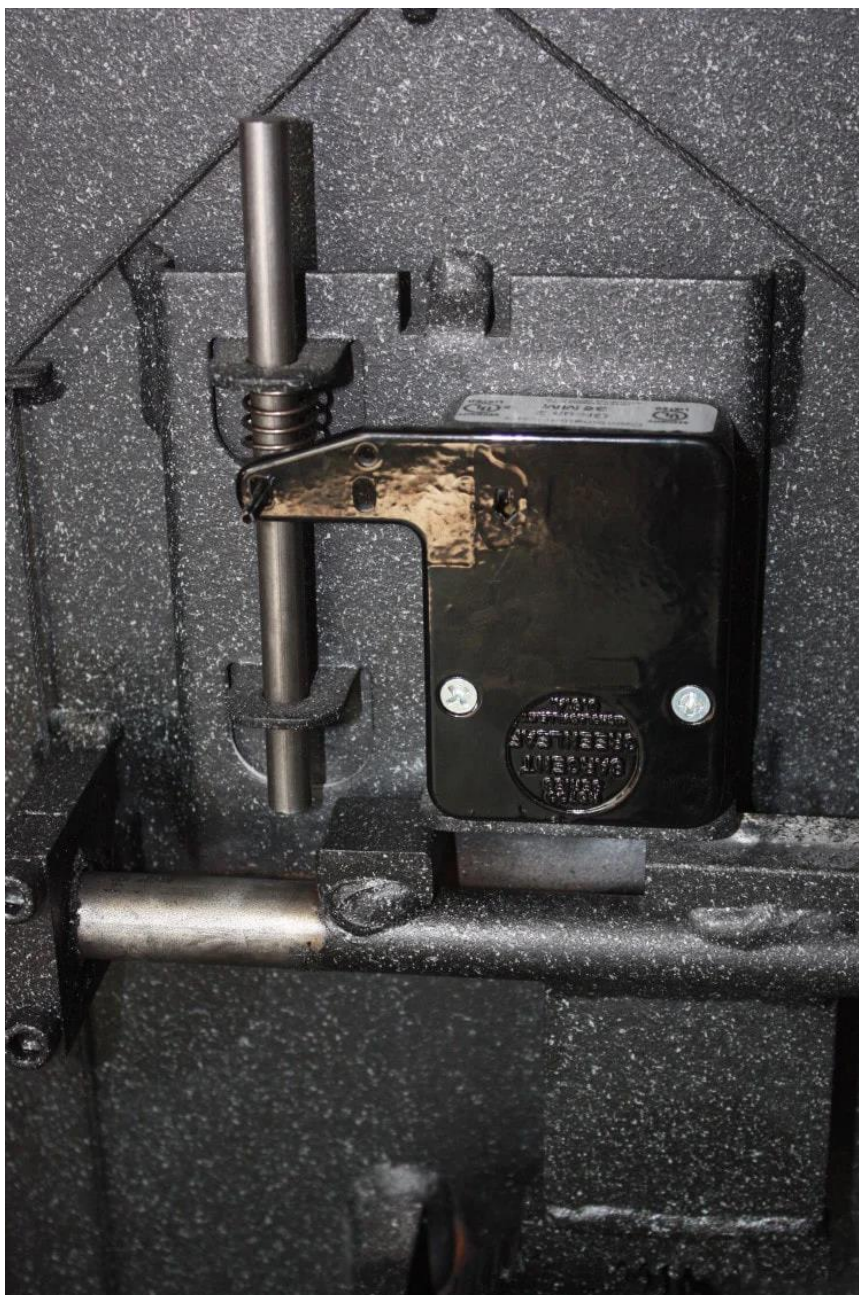
Slika 2.2 Dodatni sigurnosni mehanizam zaključavanja [4]
