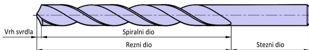
Slika 1.3. Dijelovi spiralnog svrdla [3]
