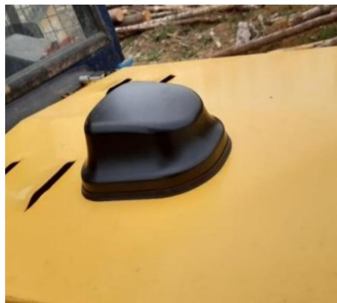
Slika 19. GPS/GSM antena [2]
