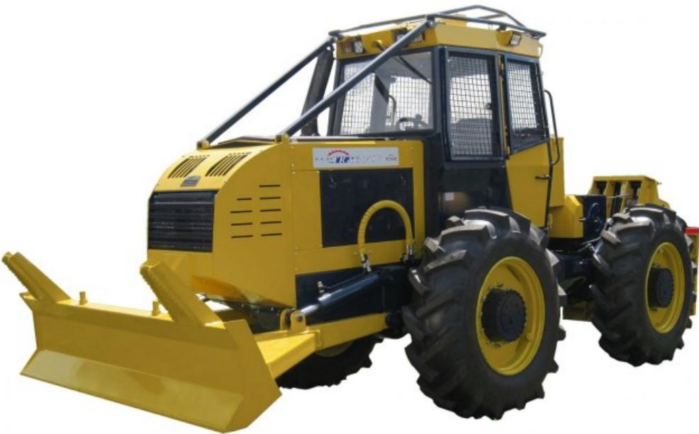
Slika 2 Šumski zglobni traktor EcoTrac 140V [2]
