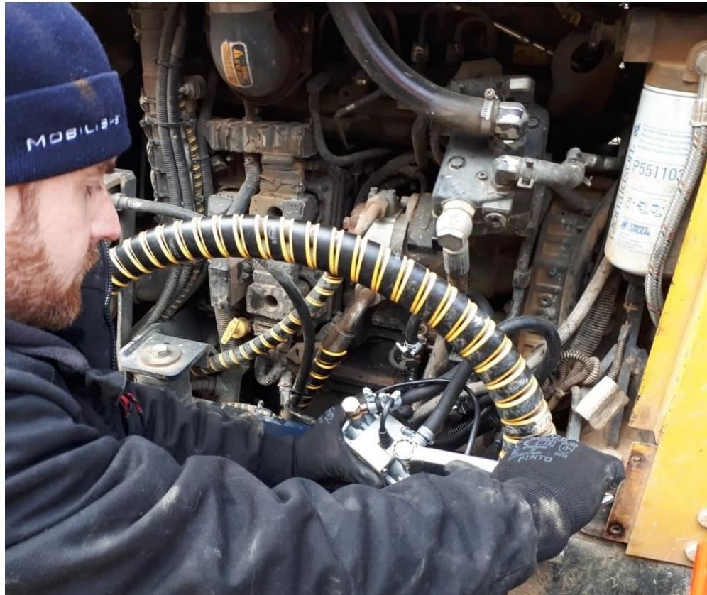
**Slika 24. Ugradnja mjerača protoka na skider [9]**
