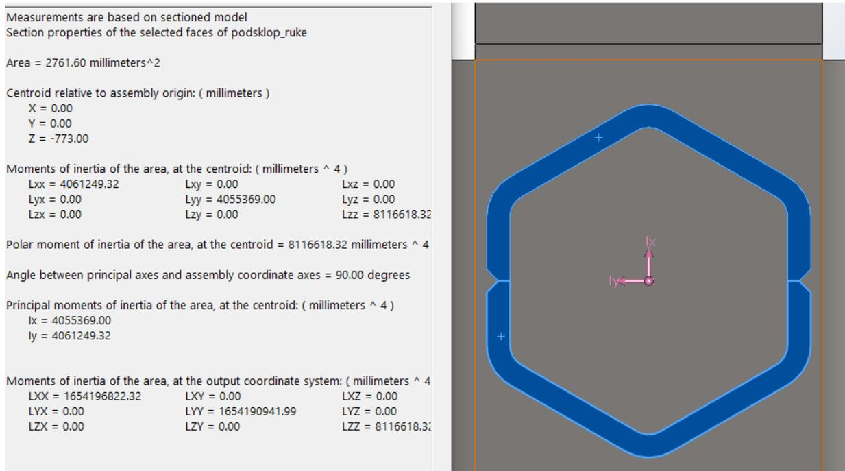
Slika 34. Poprečni presjek profila manjeg segmenta
