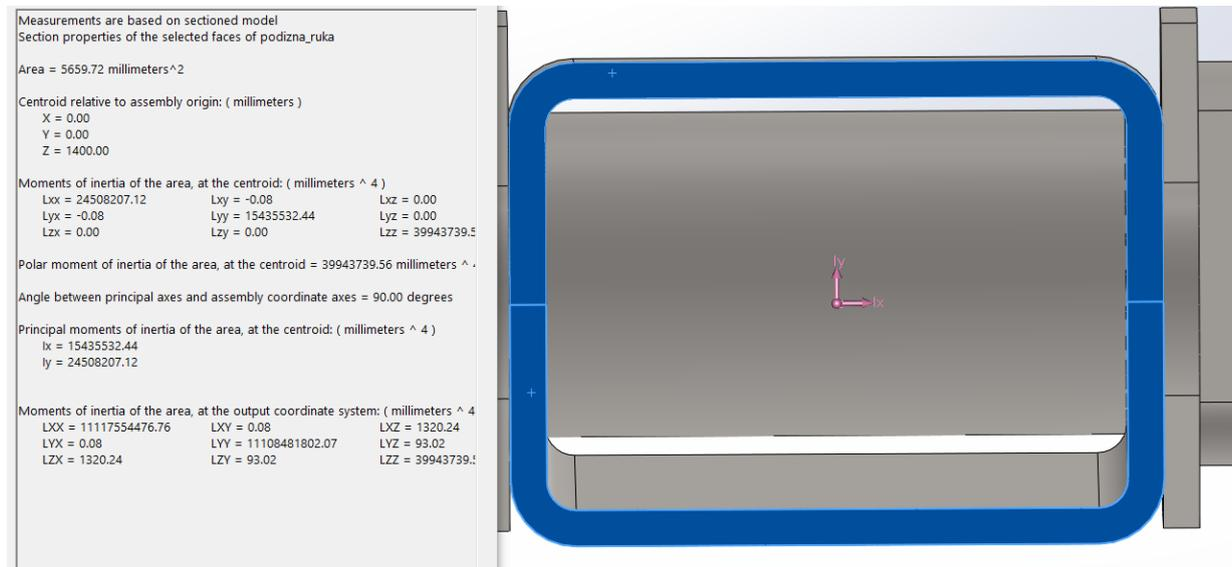
Slika 32. Poprečni presjek profila podizne ruke na poziciji 2700 mm
