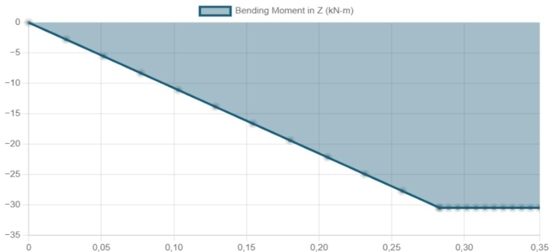
Slika 38. Dijagram momenta savijanja na vratilu
