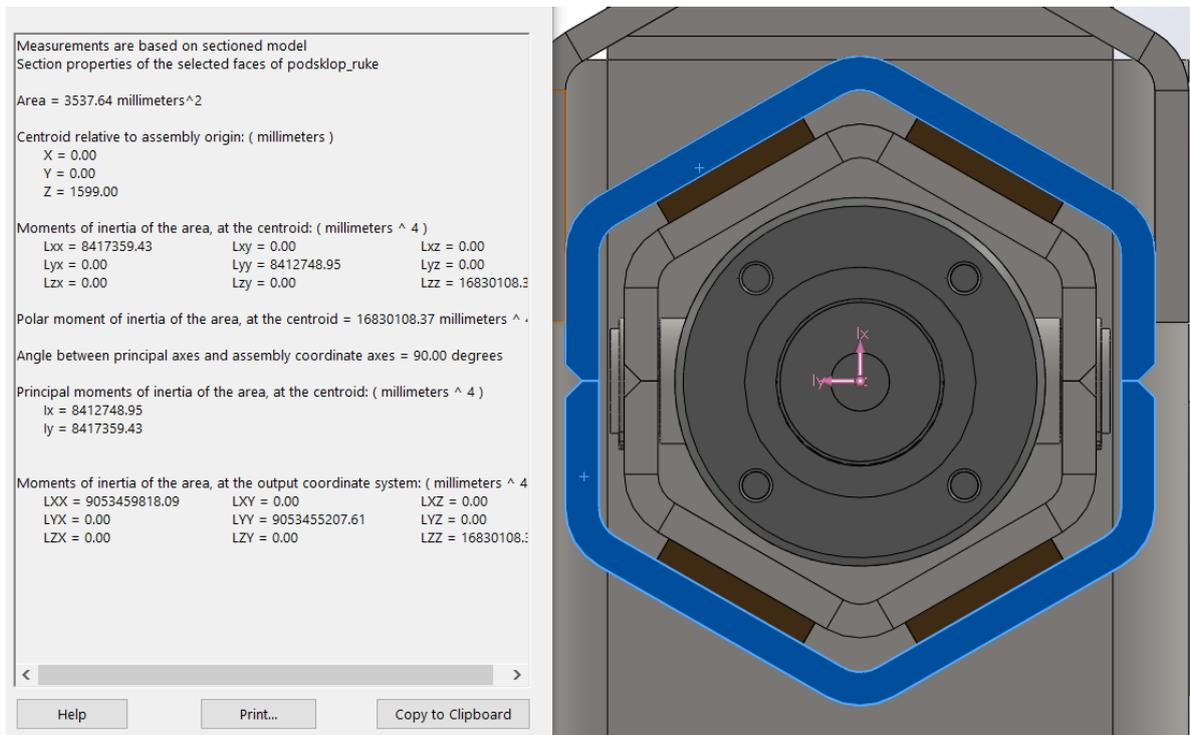
Slika 33. Poprečni presjek profila većeg segmenta
