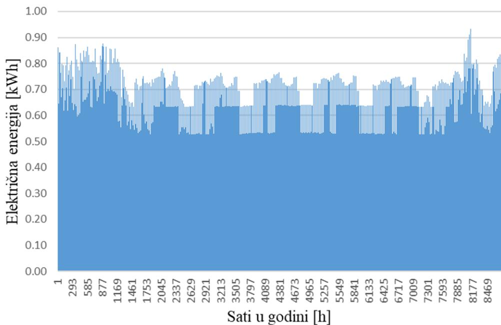
**Slika 25 Utrošak električne energije dizalice topline i električnog grijачa za zagrijavanje PTV-a**
