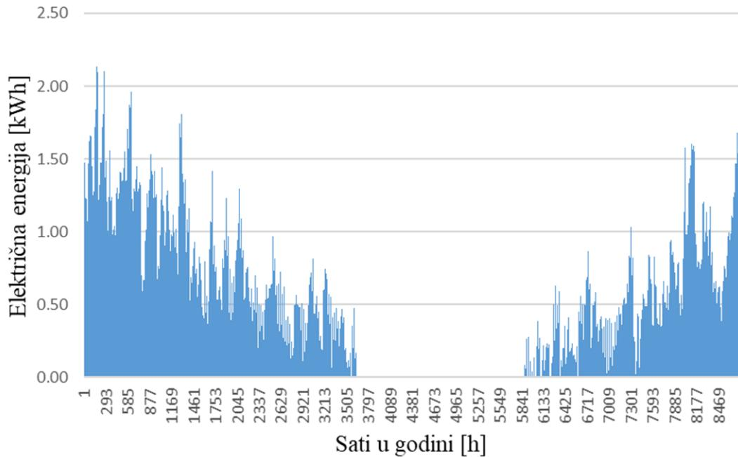
**Slika 21 Potrošnja električne energije dizalice topline u režimu grijanja**
