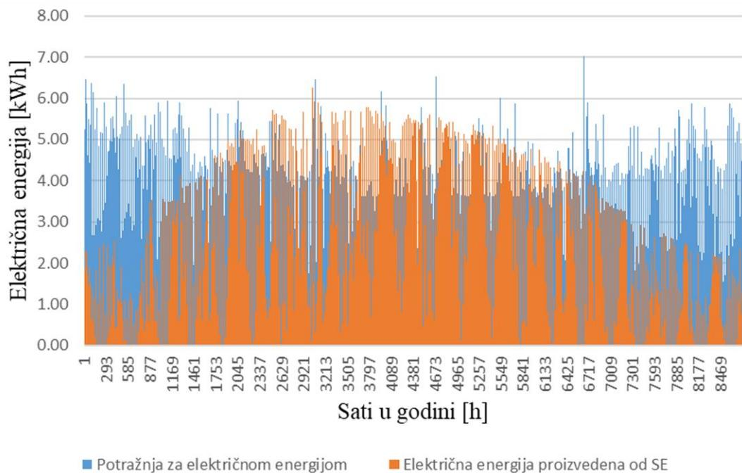
**Slika 40** Uкупna potražnja za električnom energijom i proizvedena električna energija od solarne elektrane
