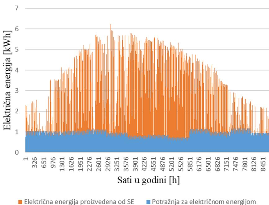
**Slika 50 Ukupna potražnja za električnom energijom i proizvedena električna energija od solarne elektrane scenarija D**
