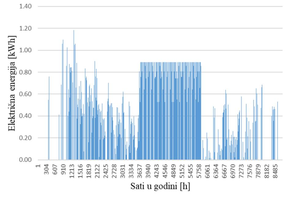
**Slika 44 Ušteda električne energije na dizalici topline**
