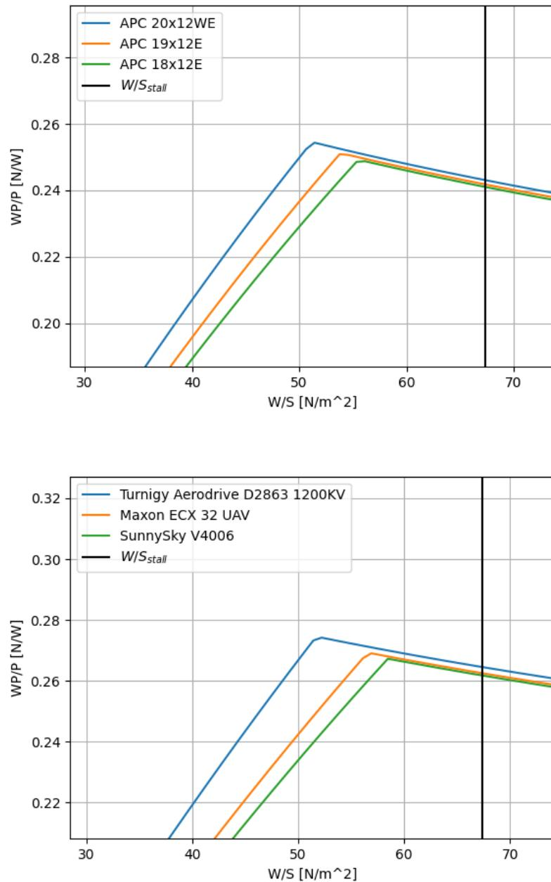
Slika 3.12: Minimalno opterećenje snagom za a) različite propelere i b) različite motore
