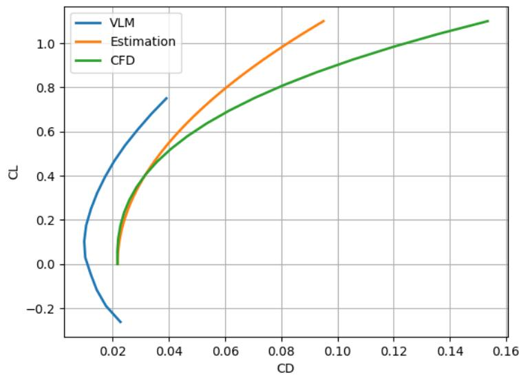
Slika 8.24: Usporedba polare otpora dobivene različitim metodama za letjelicu projektiranu s ciljem maksimizacije doleta
