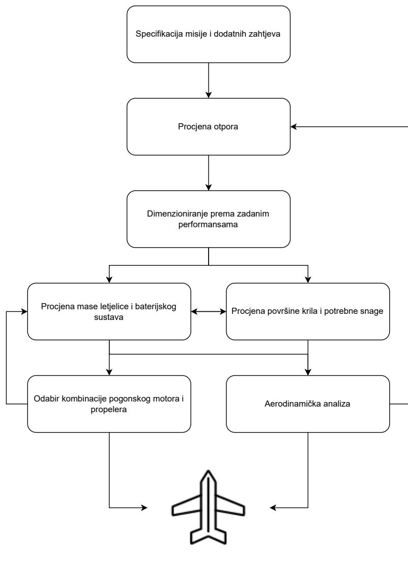
Slika 1.1: Pojednostavljena shema predloženog procesa projektiranja električnih letjelica
