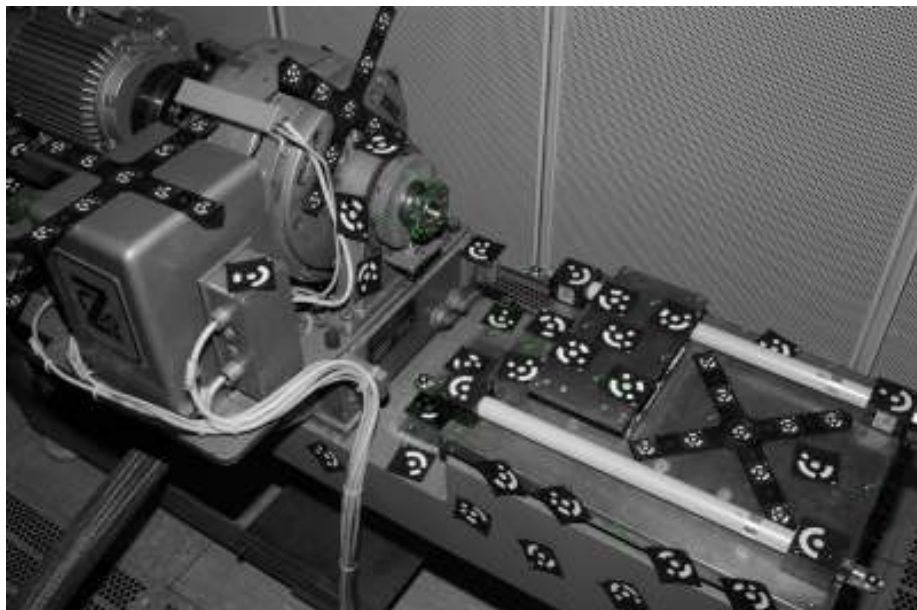
Slika 4.3. Pripremljena ispitna kočnica za fotogrametrijsko mjerenje [5.]
