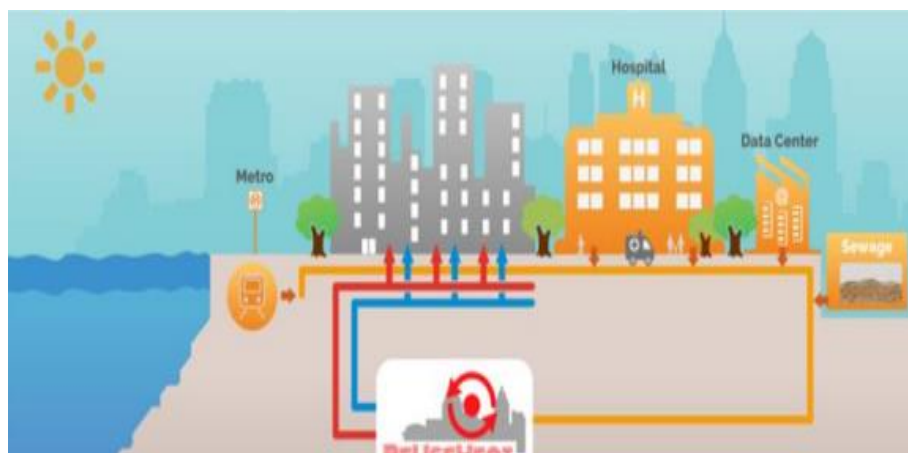
Slika 4: Shema iskorištavanja topline iz urbanih toplinskih izvora [6]
