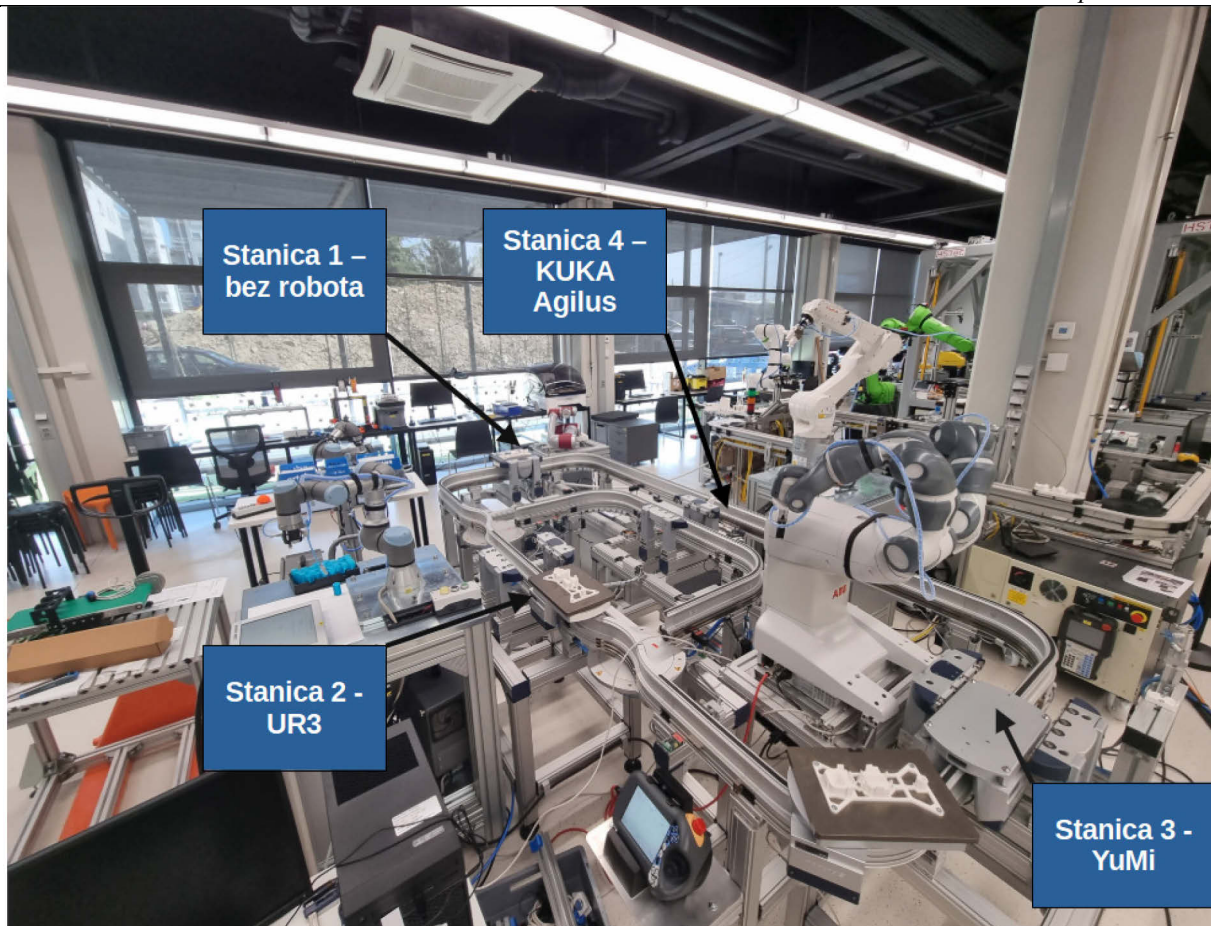
Slika 4. Montrac modul s označenim proizvodnim stanicama
