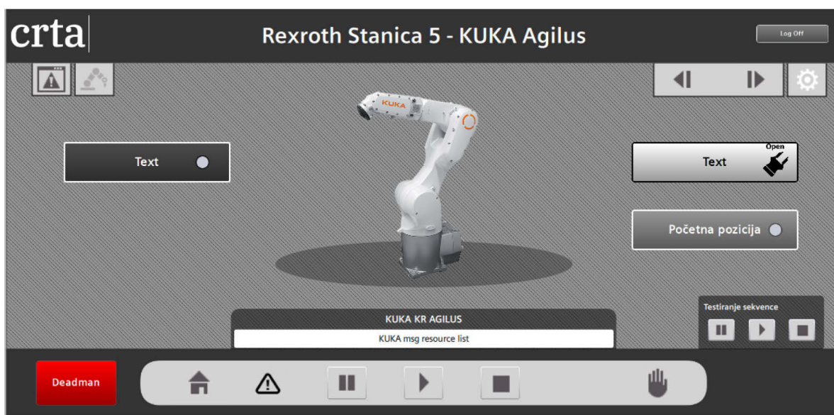
Slika 85. Potpuno definirani zaslon KUKA Agilus robota
