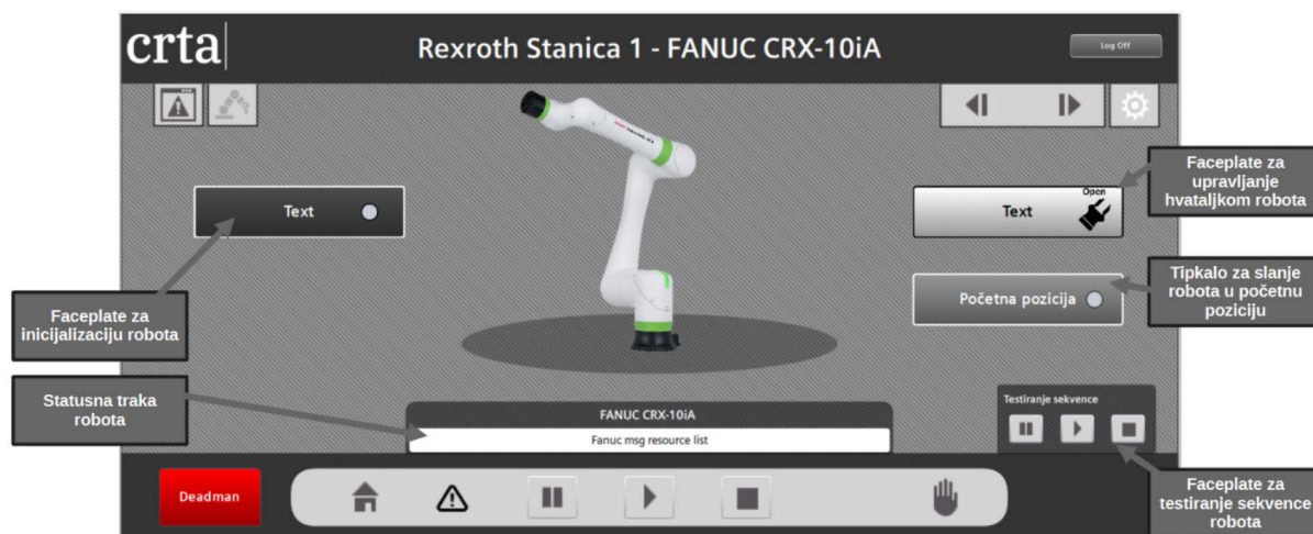
Slika 58. Potpuno definirani zaslon Fanuc CRX-10iA robota
