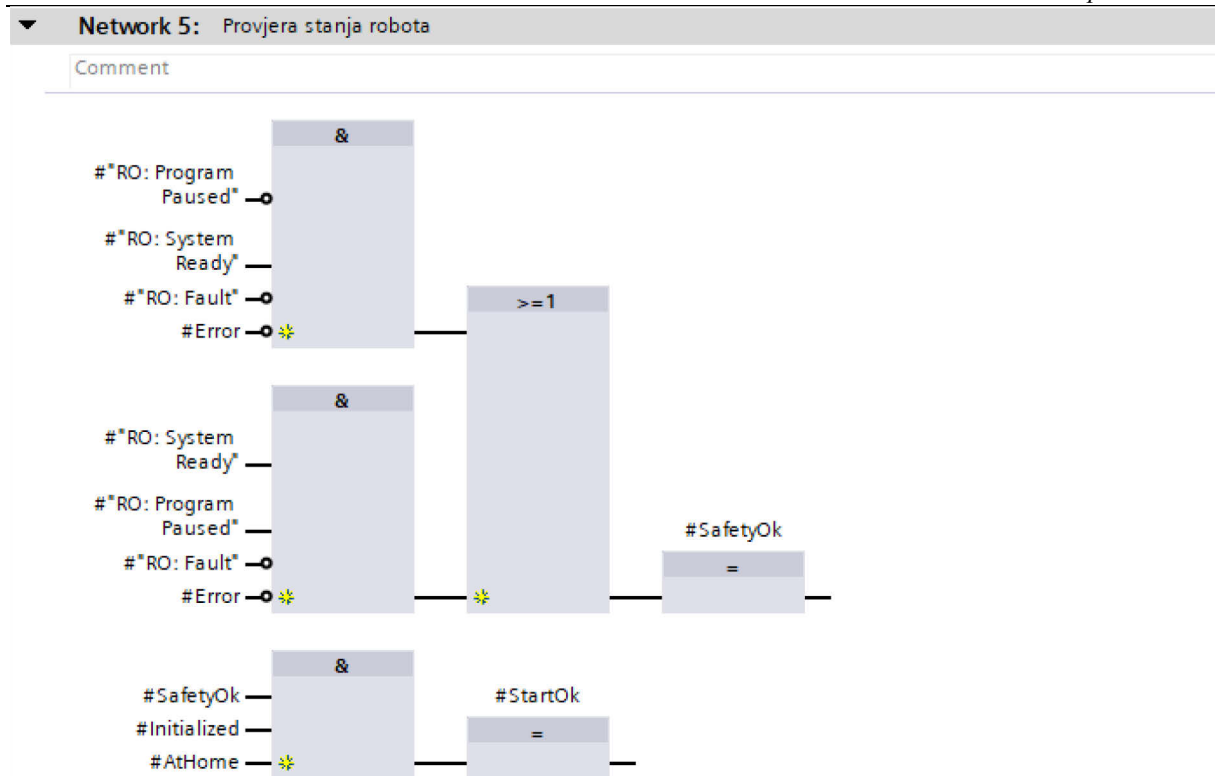
Slika 55. Logika za provjeru stanja Fanuc robota
