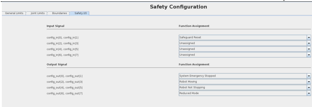
Slika 59. Konfiguracija sistemskih ulaznih i izlaznih signala na UR robotima
