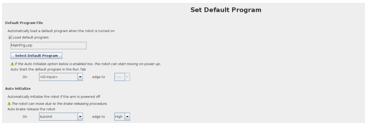
Slika 61. Odabir glavnog programa i ulaznog signala za inicijalizaciju UR robota
